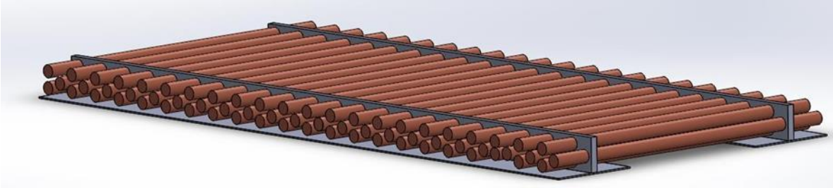
Figura 38. Sistema de acumulación con soportes.
