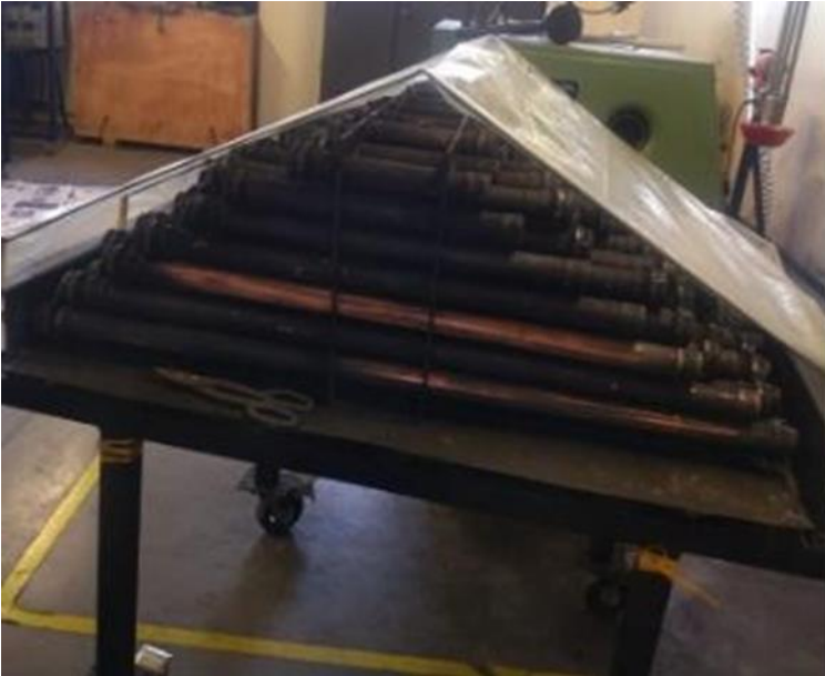
Figura 3. Sistema de acumulación sin aislar.
