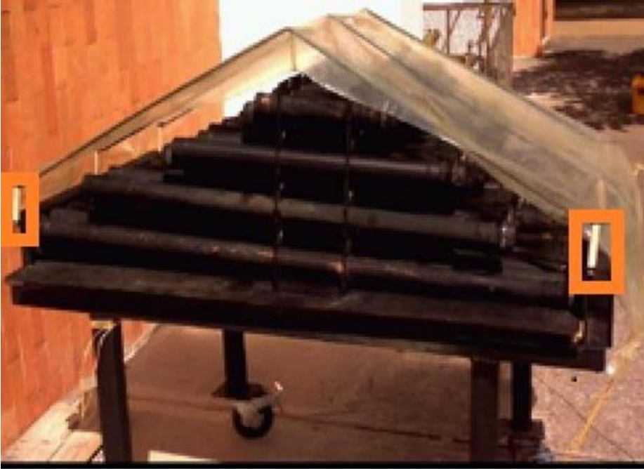
Figura 13. Expansores en el Sistema de acumulación.
