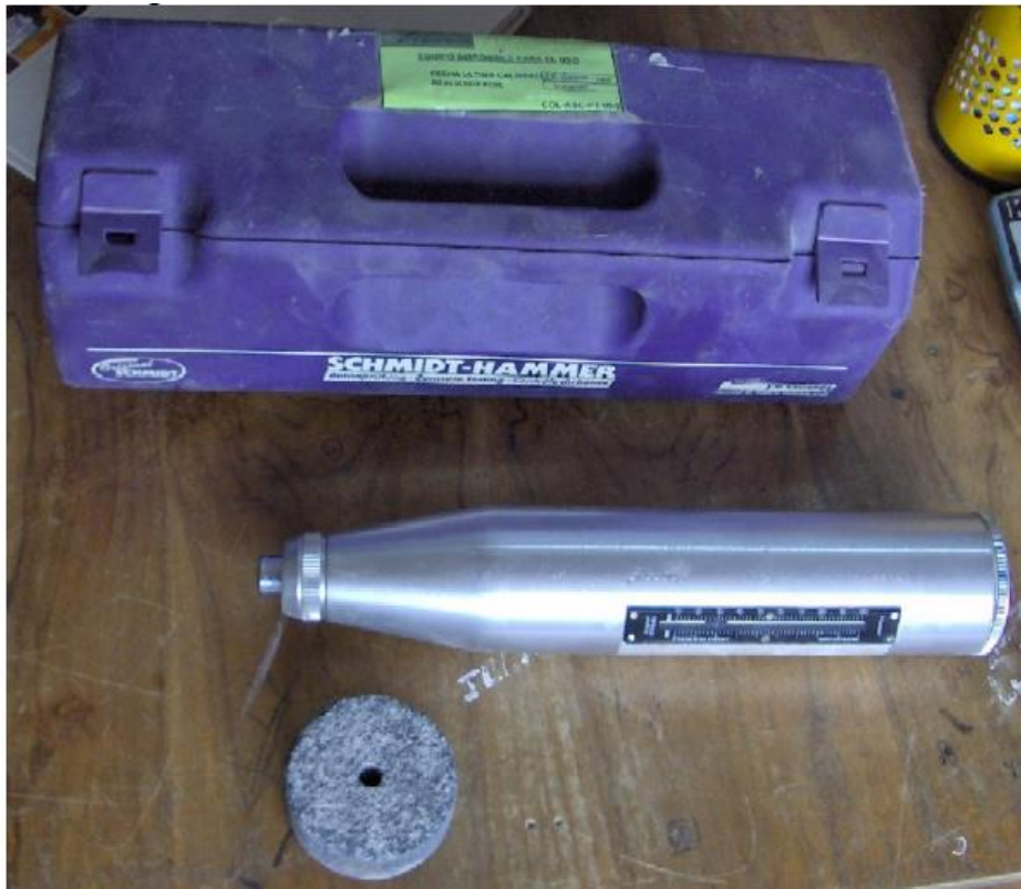
Figura 15. Esclerómetro calibrado de la empresa Geolab
