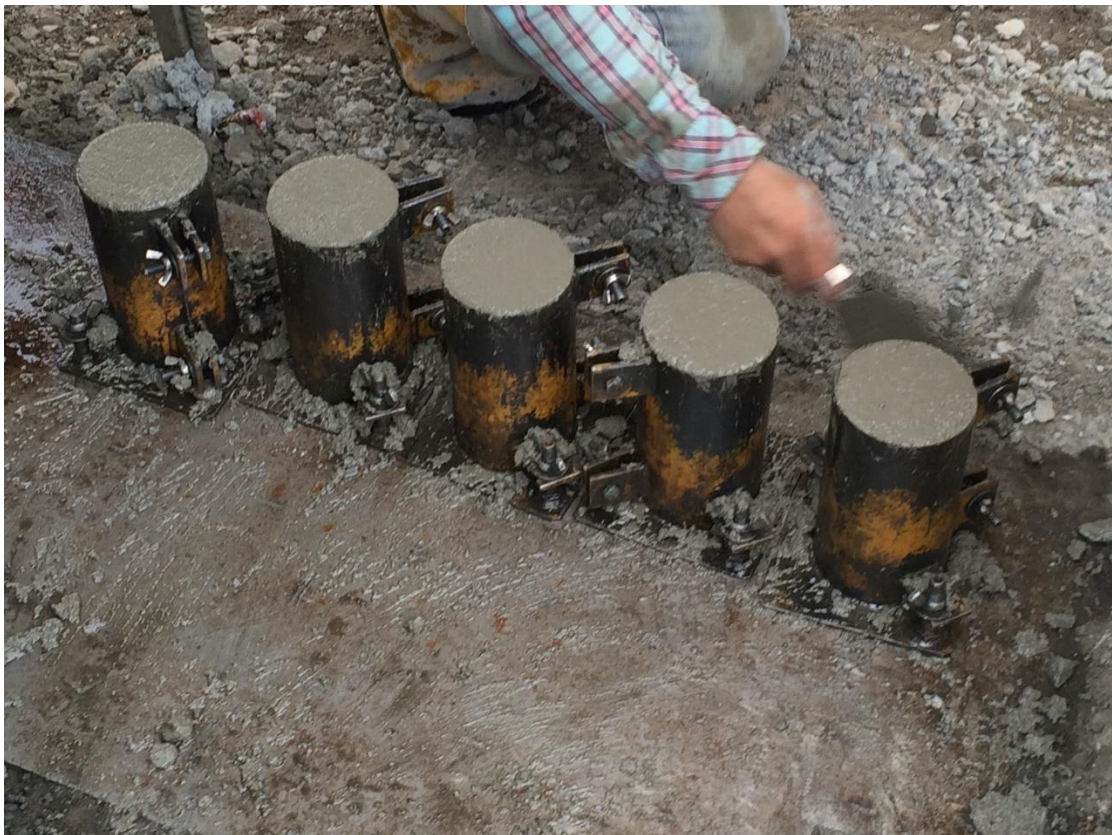
Figura 14. Muestras de concreto frescas, tomadas en obra
