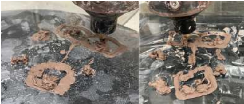
Figura 6. Tercer ensayo capa 0.4 a velocidad de 550
