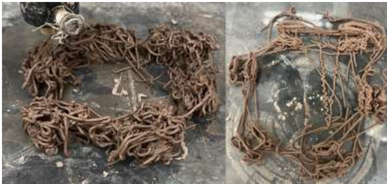
Figura 5. Segundo ensayo Capa 0.6 a 0.7 a velocidad de 600
