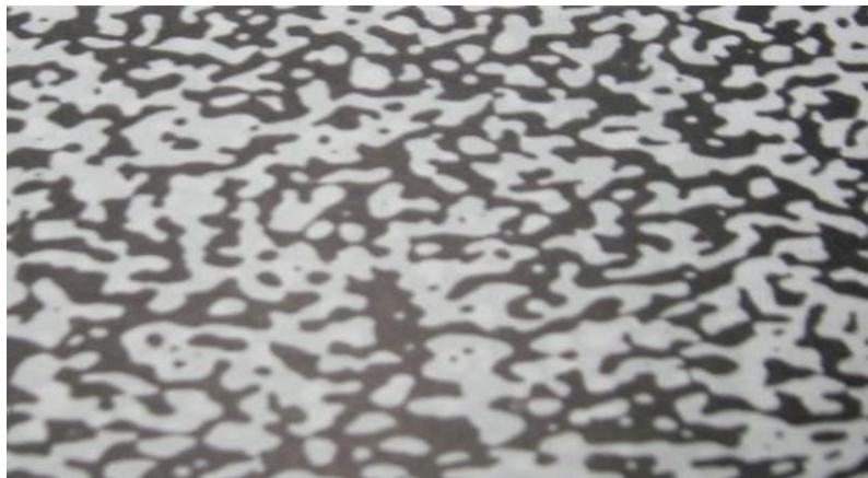
Figura 3. Microestructura de un ligante modificado con dos fases continuas
