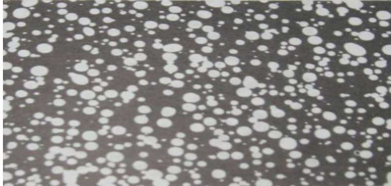
Figura 1. Microestructura de un ligante modificado con matriz de bitumen
