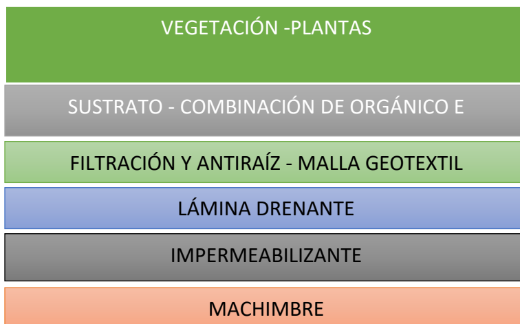
Ilustración 42 – Componentes sistema de naturaleza a instalar
