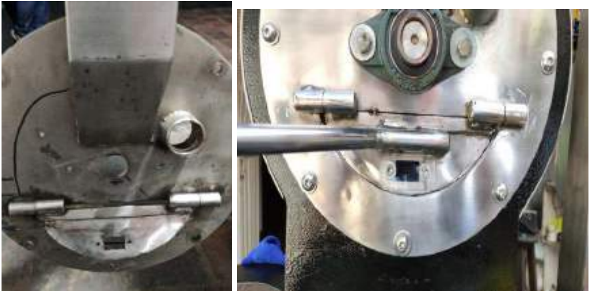
Ilustración 23 Evidencia Reajuste de Palanca y Acrílico de alta densidad
