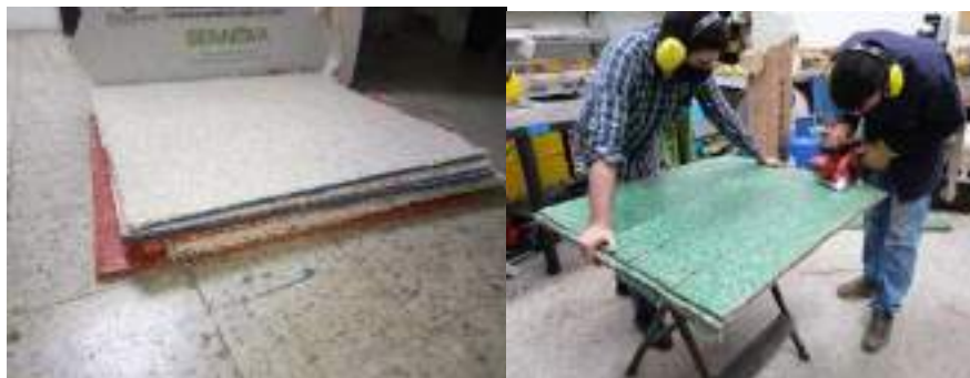
Ilustración 38 Evidencia de Manipulación Placas de polietileno alta densidad
