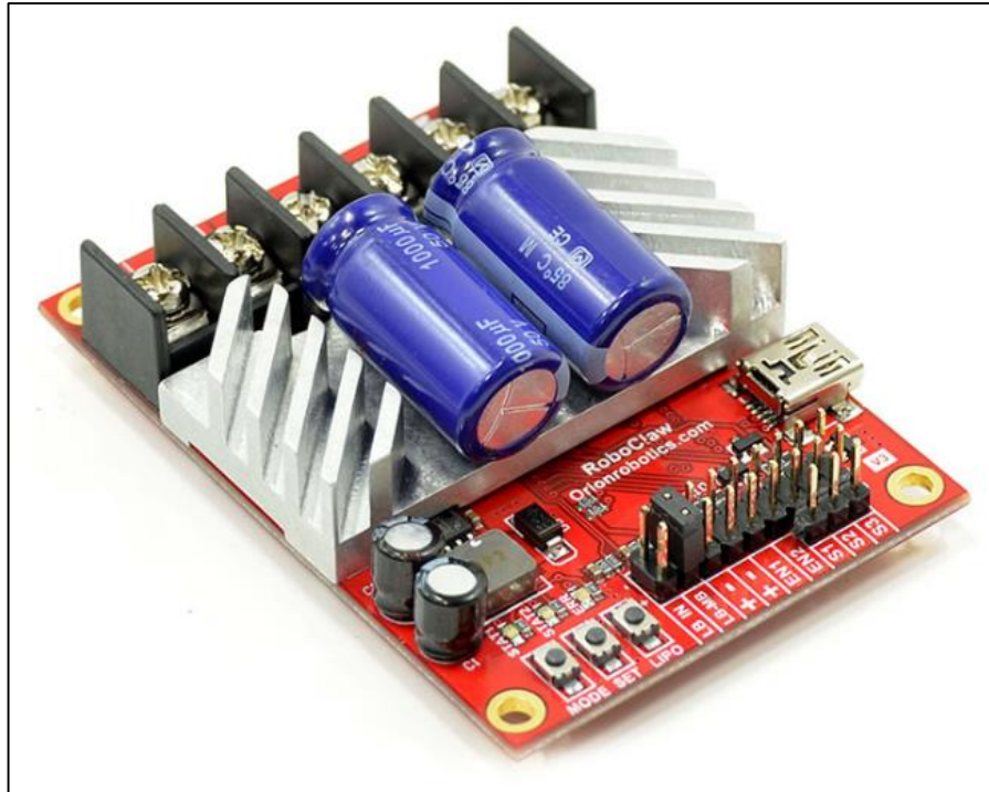
Figura 10. RoboClaw 2X30A versión 4.
