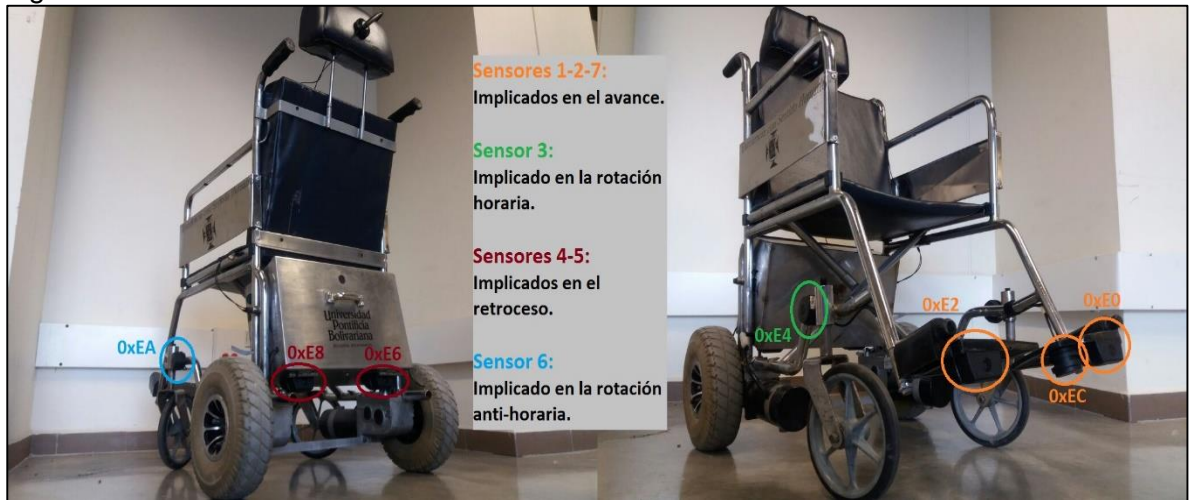
Figura 101. Foto de los sensores de ultrasonido distribuidos en la silla de ruedas.
