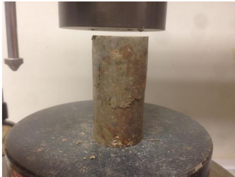
FIGURA No. 14 Compresión Simple 5% Cemento
