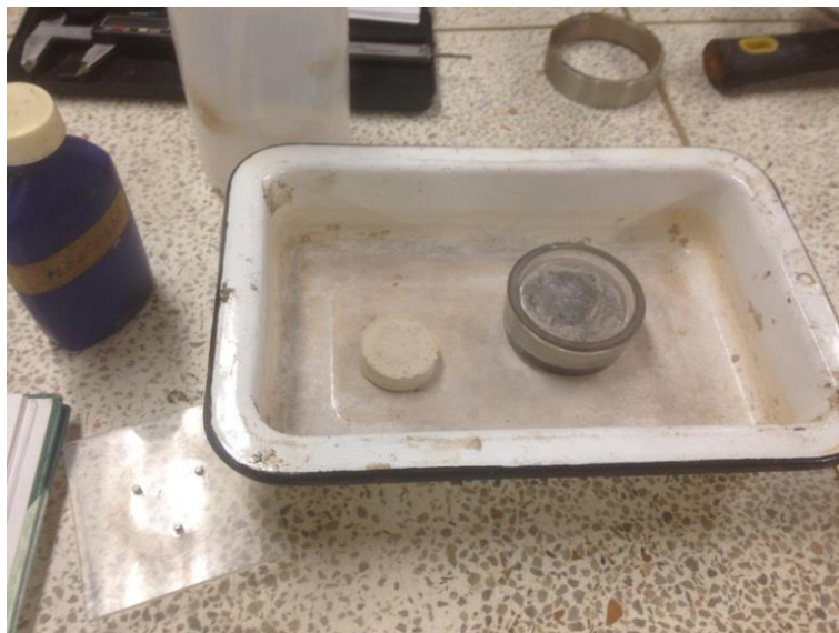
FIGURA No. 23 Limite de Contracción 15% Cemento
