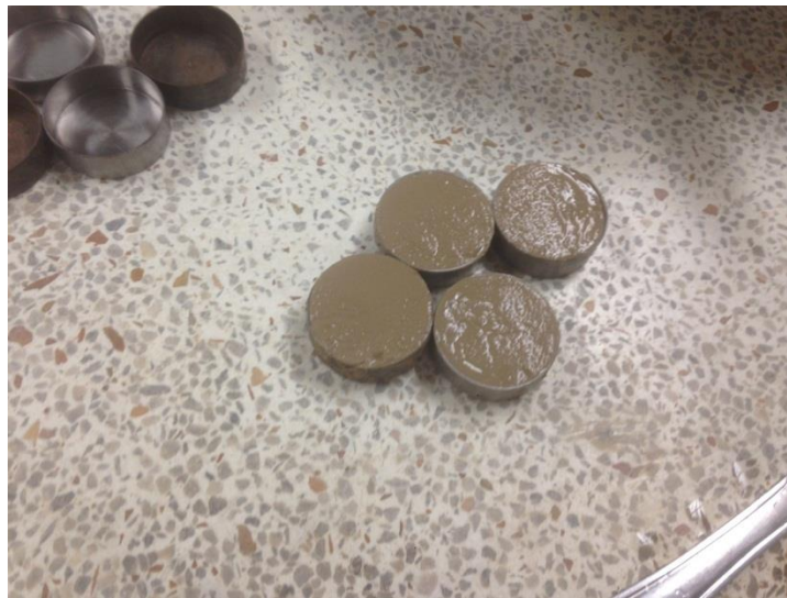
FIGURA No. 13 Límite de Contracción 5% Cemento
