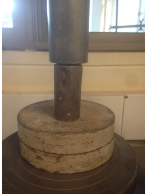
FIGURA No. 20 Compresión Simple 10% Cemento
