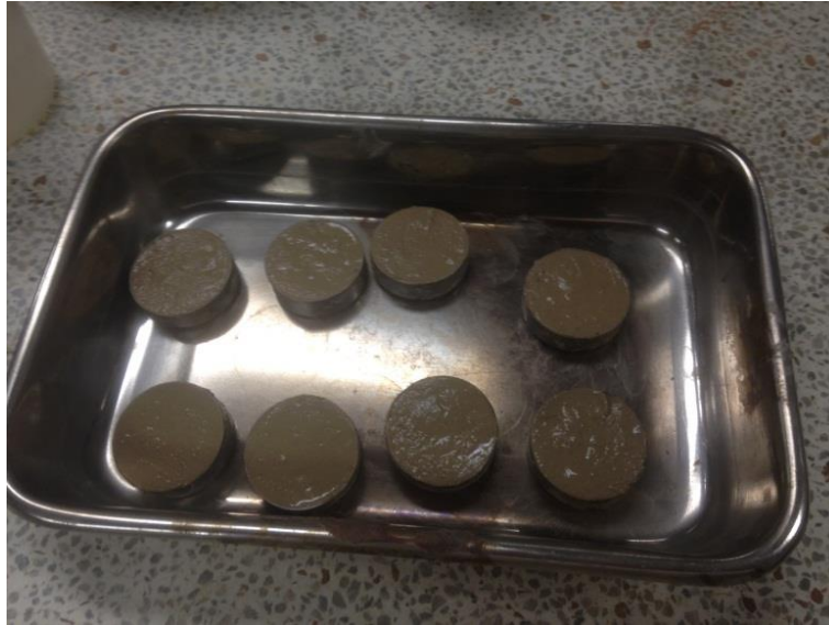
FIGURA No. 18 Limite de Contracción 10% Cemento
