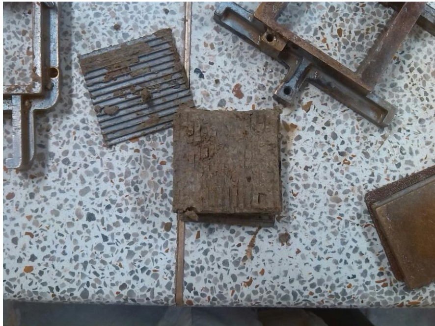
FIGURA No. 15 Corte Directo 5% Cemento
