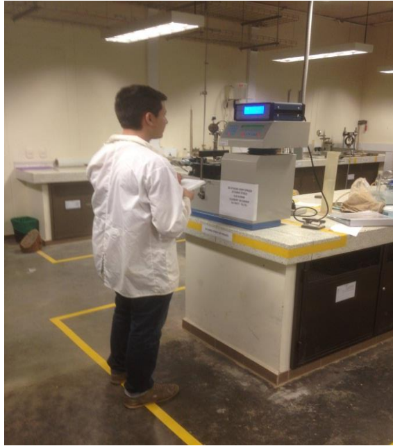
FIGURA No. 21 Corte Directo 10% Cemento
