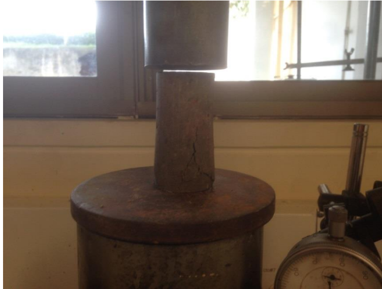
FIGURA No. 24 Compresión Simple 15% Cemento
