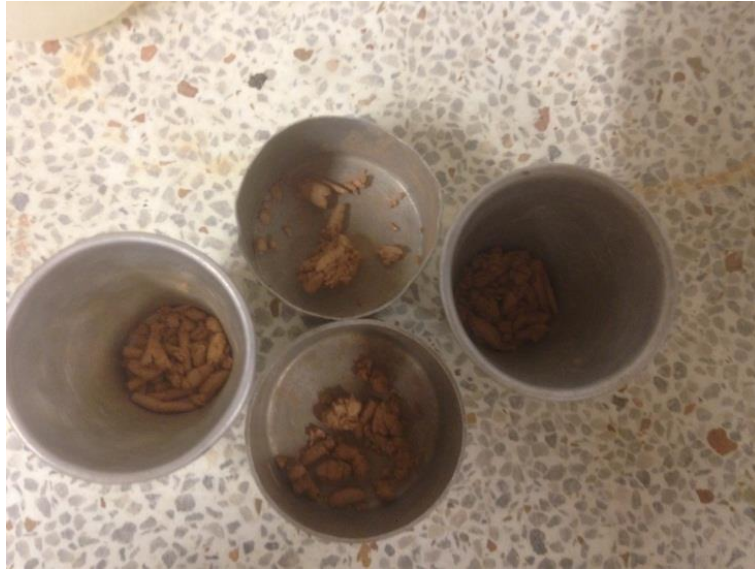
FIGURA No. 22 Limite Plástico 15% Cemento
