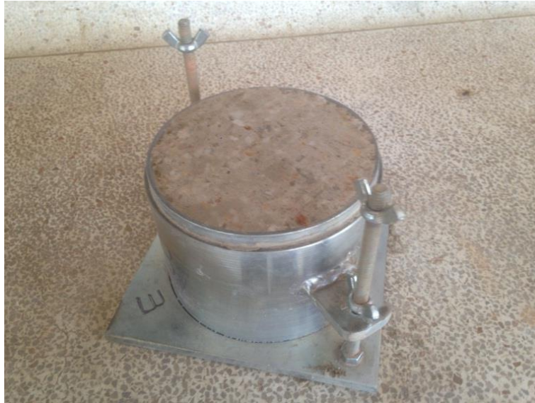
FIGURA No. 19 Proctor Modificado 10% Cemento
