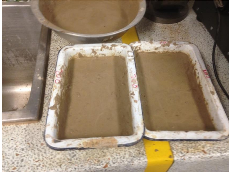
FIGURA No. 17 Limite Plástico 10% Cemento
