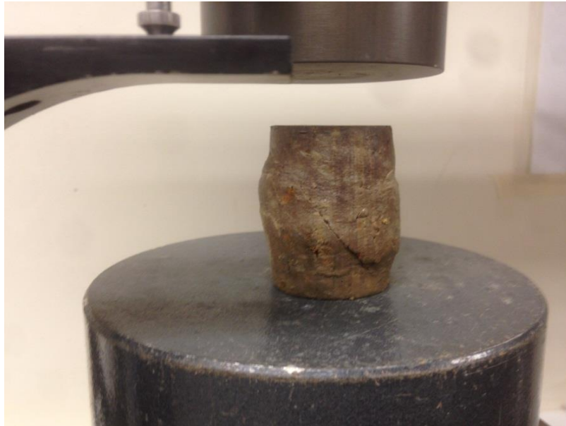
FIGURA No. 10 Compresión Simple
