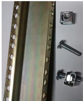
Riel de montaje en el Rack detallado
