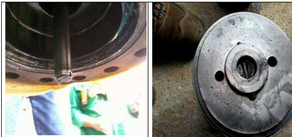
Figura 32. Ruptura del Vástago 16-10-2010
