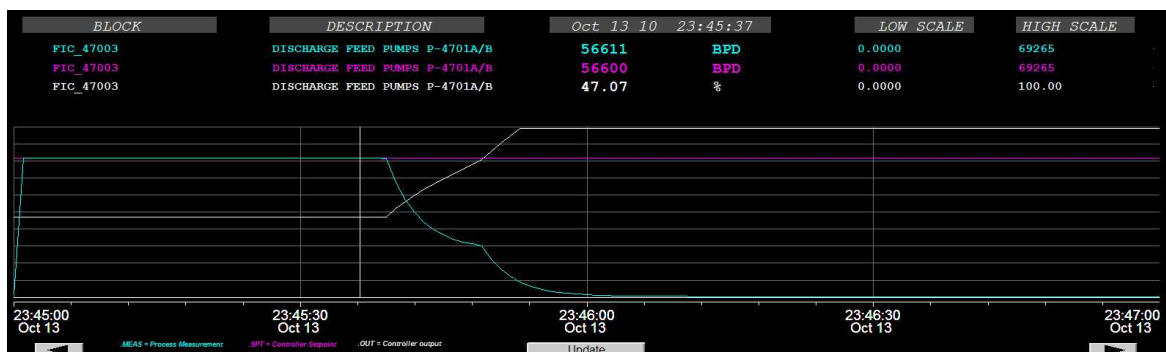
Figura 25. Tendencia Corte de Carga a la Unidad FV-47003 y Respuesta del Controlador FIC-47003 13-10-2010.
