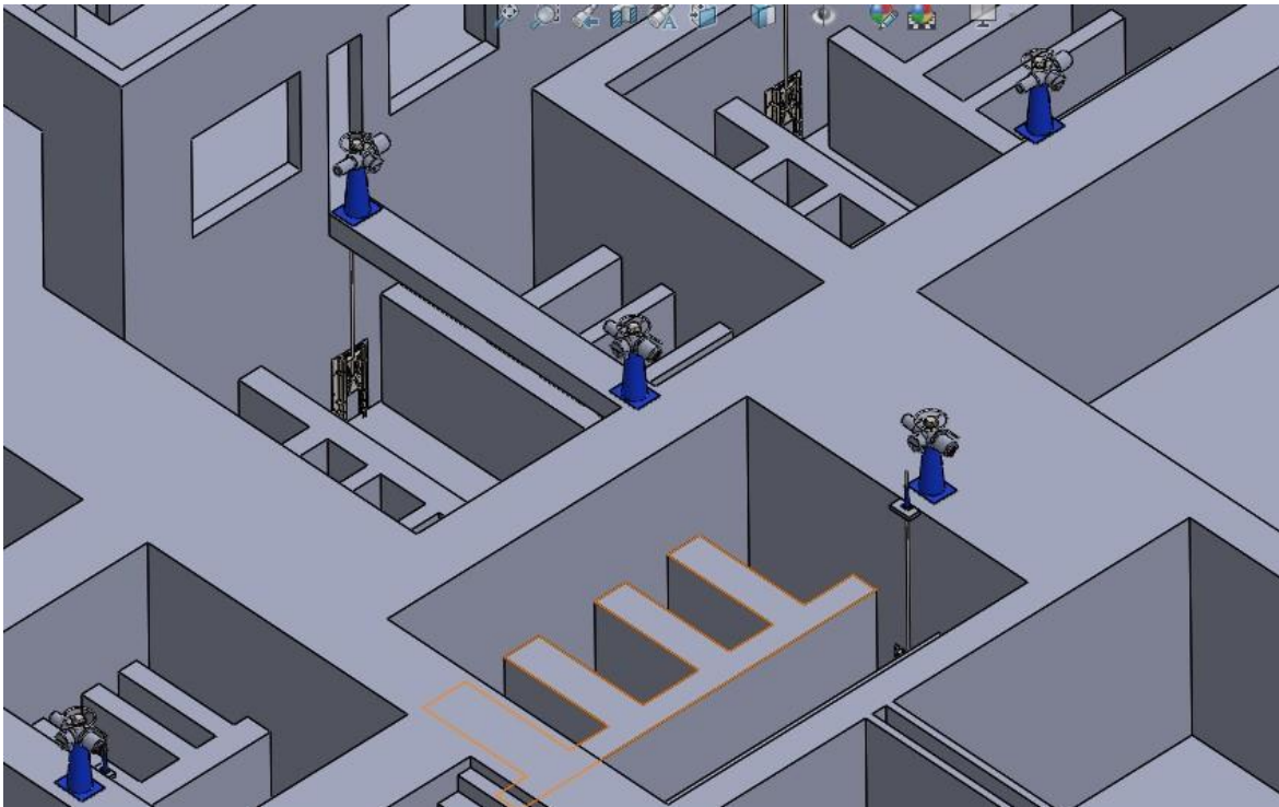
Figura 13. Distribucion de las Válvulas de Paso
