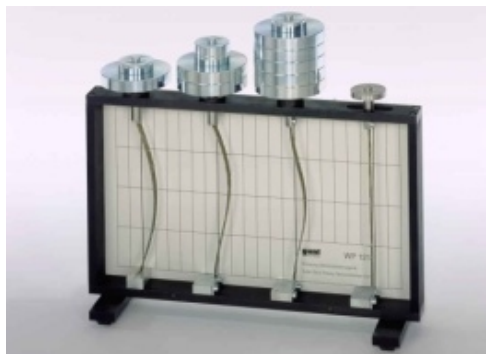
FIGURA 9. Modelo de los distintos tipos de pandeo de Euler.
