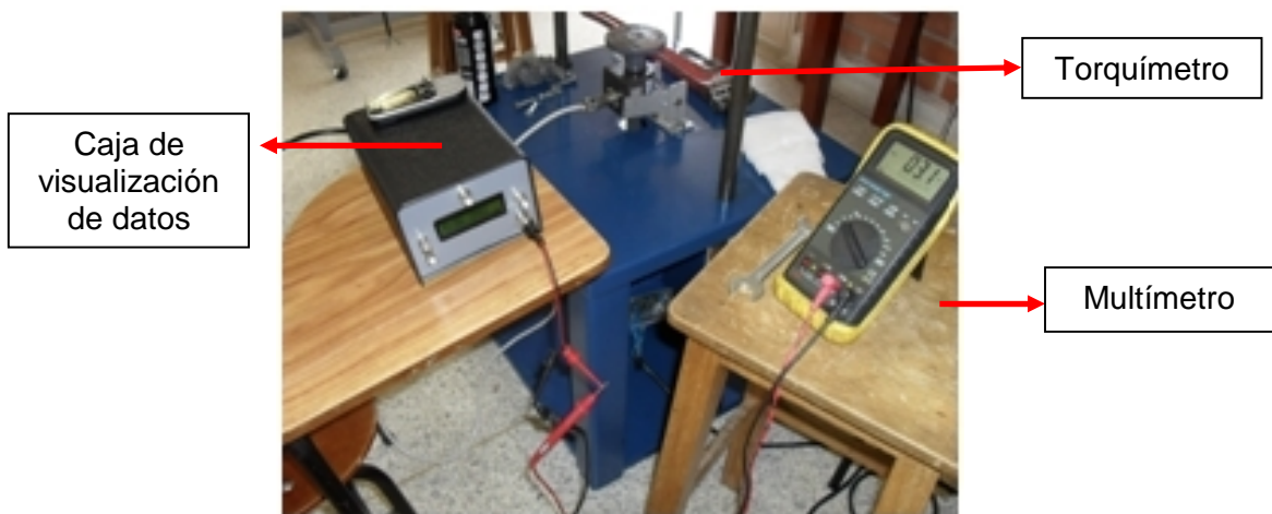
FOTOGRAFIA 3. Conexión del torquímetro
