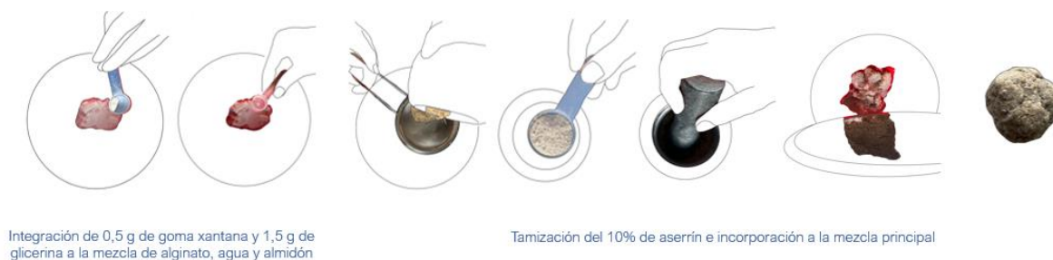
Figura 1. Metodología (a) ilustraciones representativas de la preparación inicial del almidón y (b) Ilustraciones representativas de la incorporación de goma xantana, glicerina y el proceso de tamización de residuos madereros. Autoría propia.
