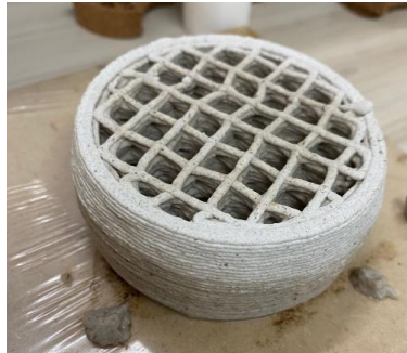
Figura 7. Refuerzo estructural interno de la pieza impresa. Autoría propia.
