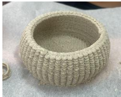
Figura 4. Pieza recién impresa. Una de las piezas con mejor aspecto y resistencia obtenida. Autoría propia.
