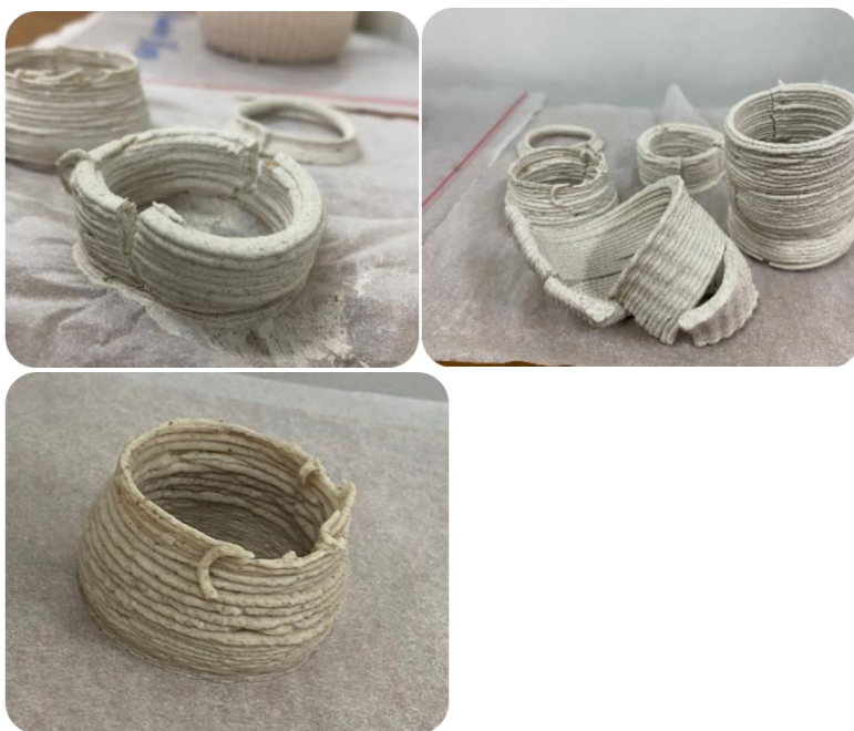
Figura 2. Imágenes demostrativas de comportamientos del material luego de su impresión. Autoría propia.
