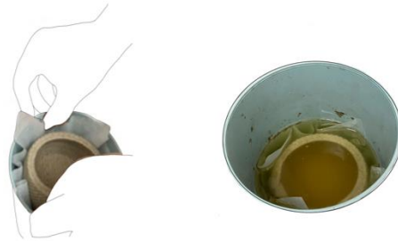
Figura 3. Inmersión del material en solución de cloruro de calcio. Autoría propia.
