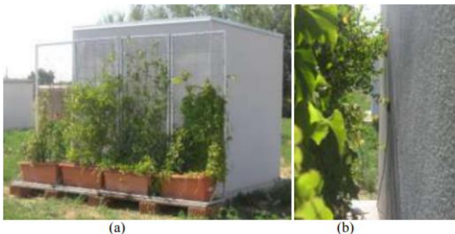
Figura 4 -Montaje experimental de fachada verde para estudio de aislamiento acústico. Adaptado de “Green vertical systems for buildings as passive acoustic insulation,” por G. Pérez
