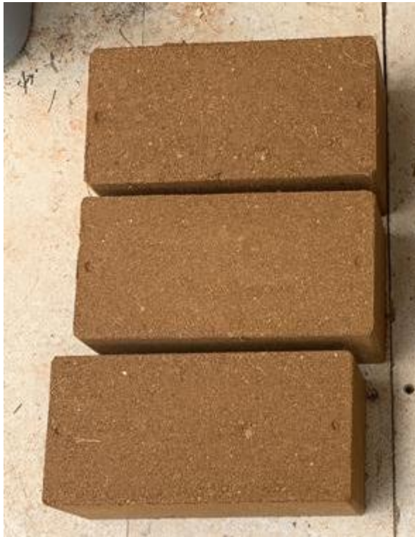
Figura 19. Ladrillos con Diferente Humedad
