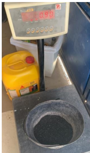
Figura 22. Caucho para la Preparación de la Mezcla
