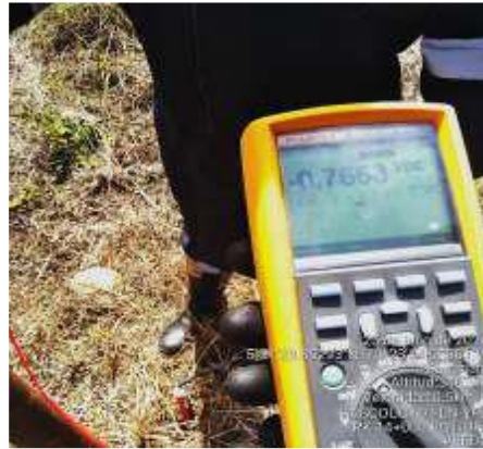
Fig. 30 Medición de Potencial Instant OFF
