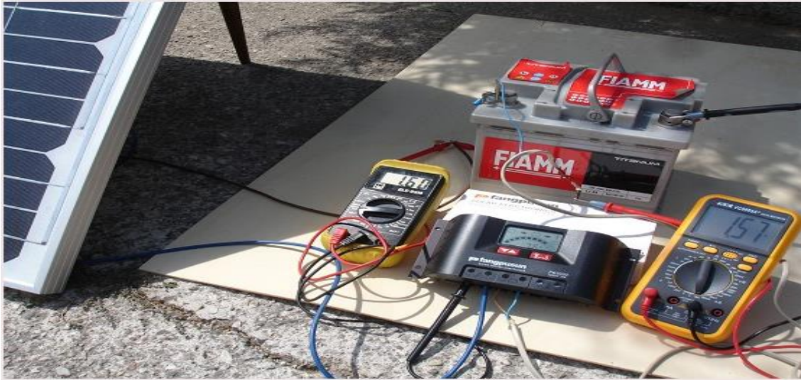
Imagen 13. Comportamiento de un regulador de carga PWM (PR3030)
