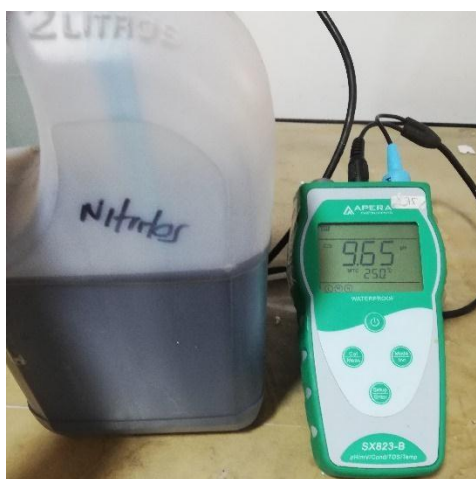
Ilustración 14. Medición de Ph a los Residuos Liquidos Peligrosos
