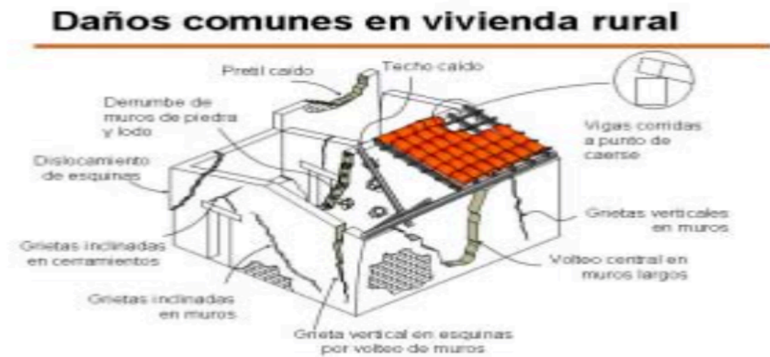
Figura 18. Daños comunes en viviendas rurales
