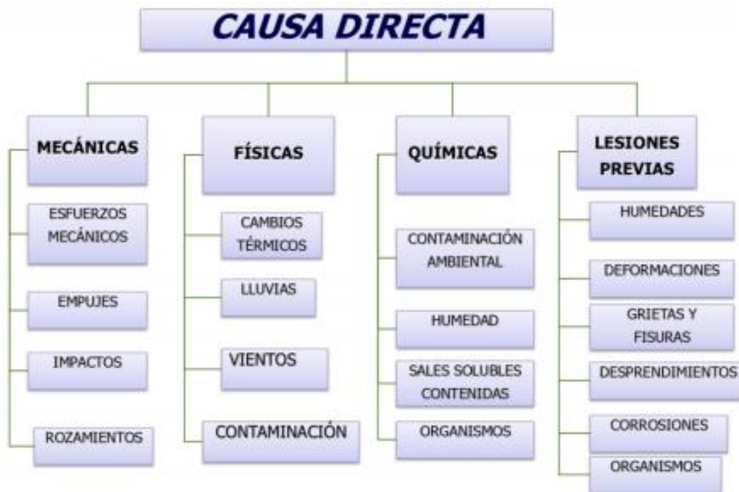
Figura 1. Causas Directas donde se ubican las lesiones por humedad
