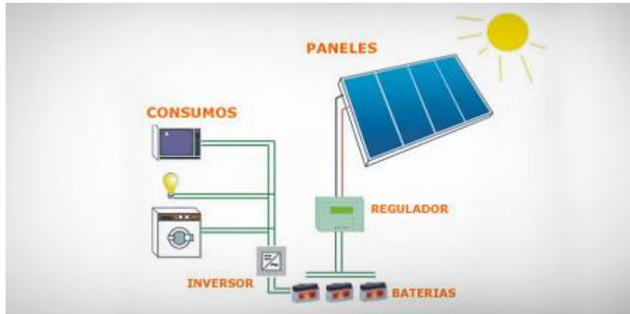
Figura 13. Sistema de energía solar por medio de paneles solares fotovoltaicos.
