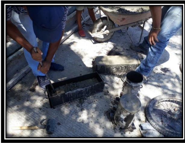
Imagen 6 Ensayo a flexión sobre viguetas de concreto. Fuente:(Elaboración Propia)
