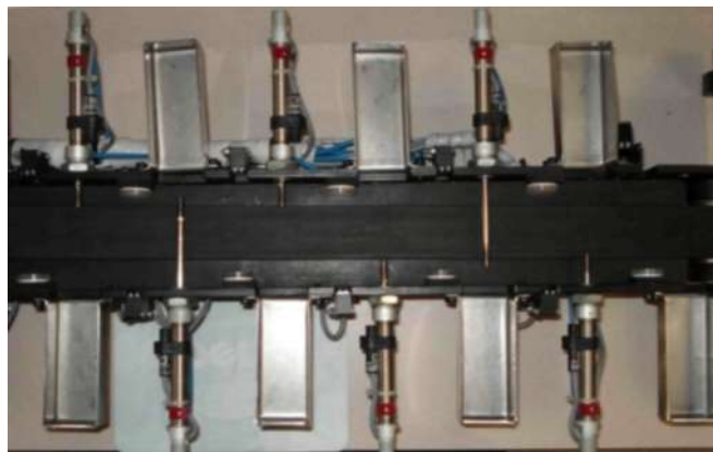
Figura 3.3 Banda transportadora, cilindros neumáticos y sensores ópticos.
