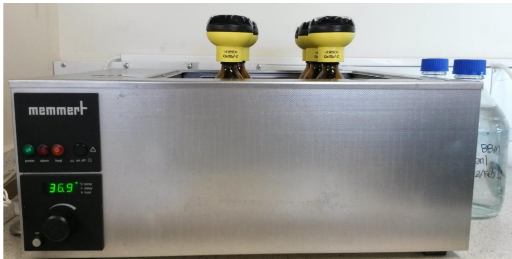
Imagen 6. Montaje de Actividad Metanogénica.
