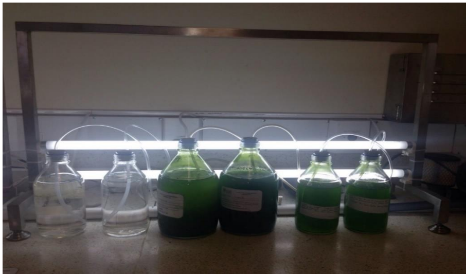
Figura 13. Configuración final del sistema de iluminación en funcionamiento.
