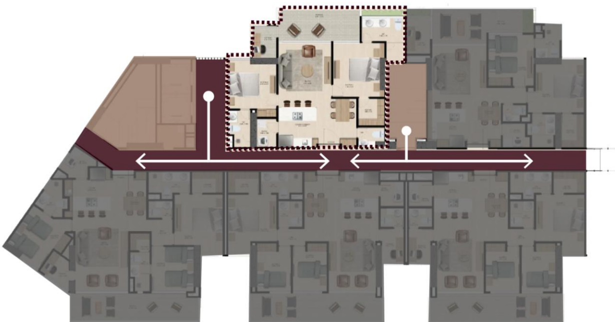
Imagen 37. Planta típica del doceavo piso del edificio, mostrando puntos fijos, corredores y el acceso a los apartamentos. Elaboración propia.
