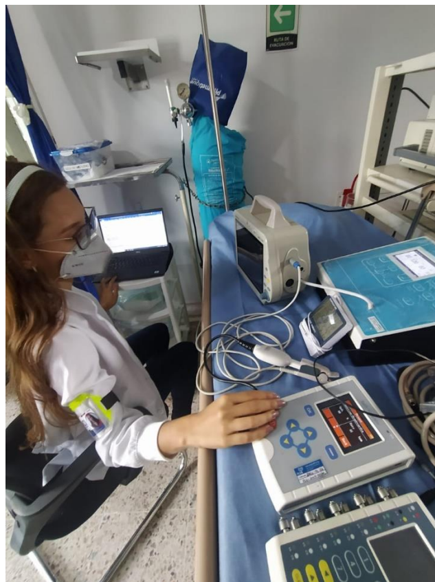
Ilustración 37. Calibración monitor de signos vitales
