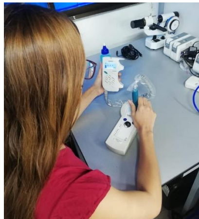
Ilustración 27. Calibración Doppler fetal
