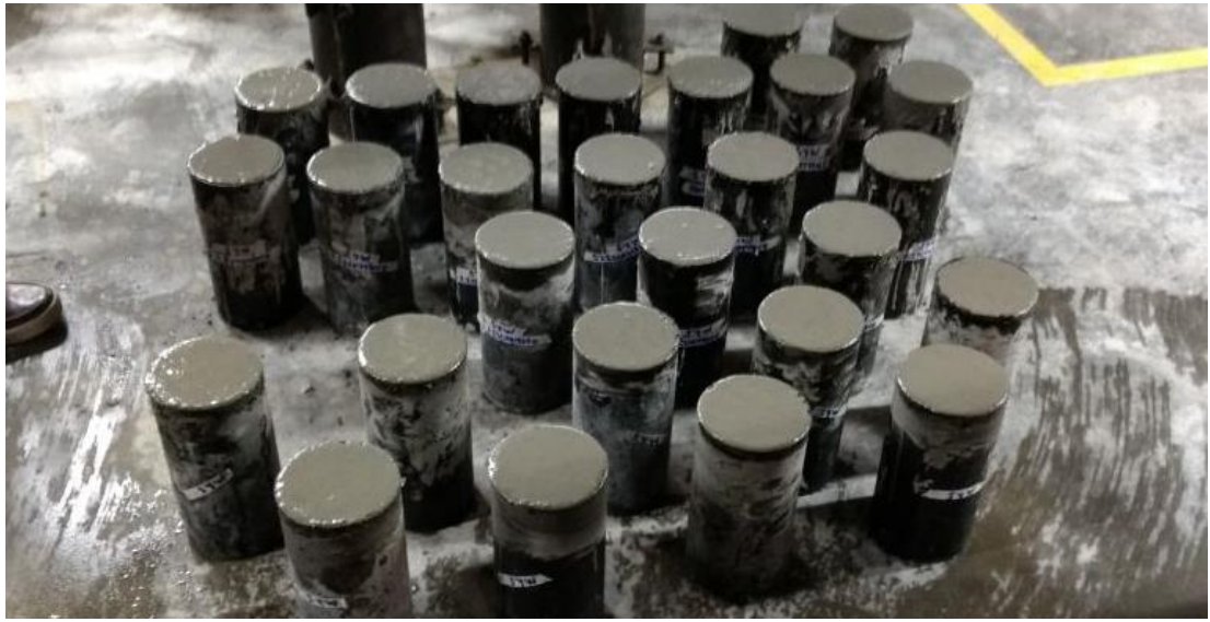
Figura 14. Cilindros de Concreto fresco
