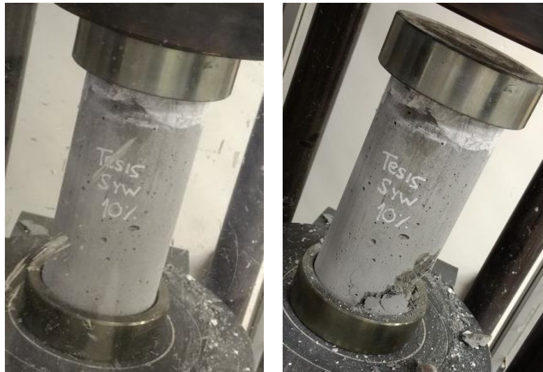
Figura 19. Ensayo a compresión del concreto
