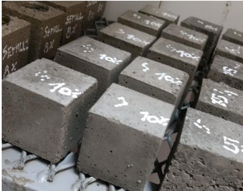
Figura 18. Cubos de Mortero endurecido.
