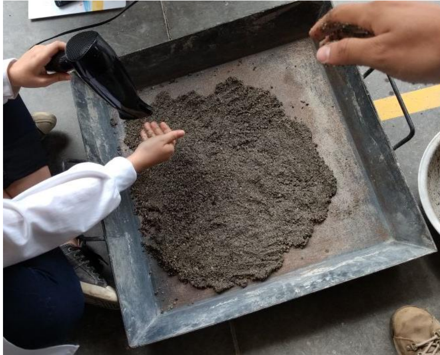
Figura 6. Proceso de secado para conseguir el estado del material saturado superficialmente seco para el ensayo de absorción
