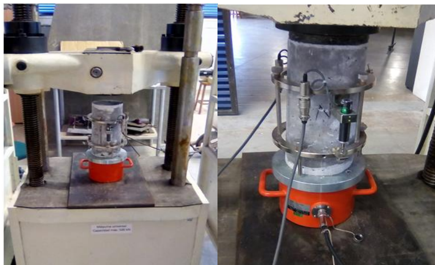
Imagen 29: Ensayo de Módulo de Elasticidad en Máquina Universal.
