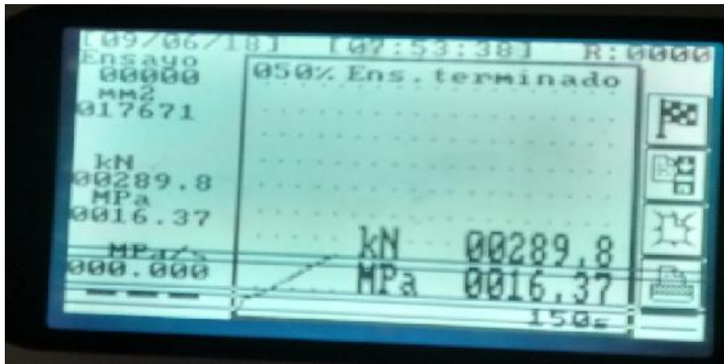
Imagen 24: Lectura Máquina de Compresión 28 Días Especímenes Mezcla al 2%.
