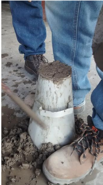
Imagen 13: Llenado por Capas del Cono de Abrams para Verificación de Asentamiento.
