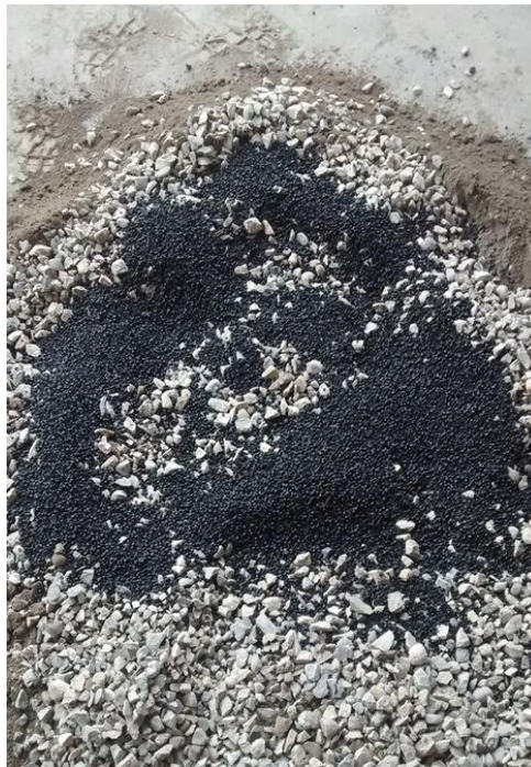
Imagen 1 Fase de Pre-Mezclado del Concreto Alternativo con 4% de Sustitución de Agregado Grueso.
