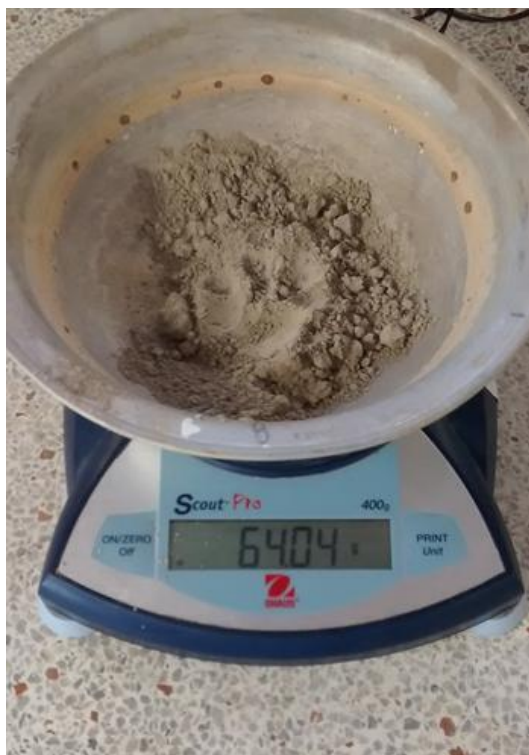
Imagen 10. Ensayo de Densidad del Cemento, Cantidad de Cemento Empleada.
