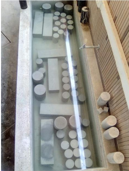
Imagen 18: Curado de Especímenes.
