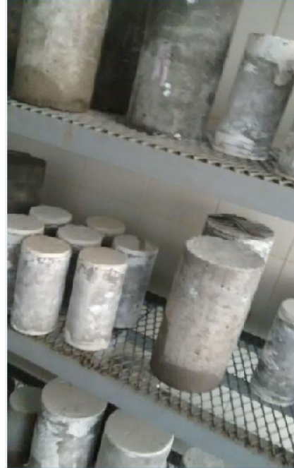
Imagen 18: Curado de Especímenes.
