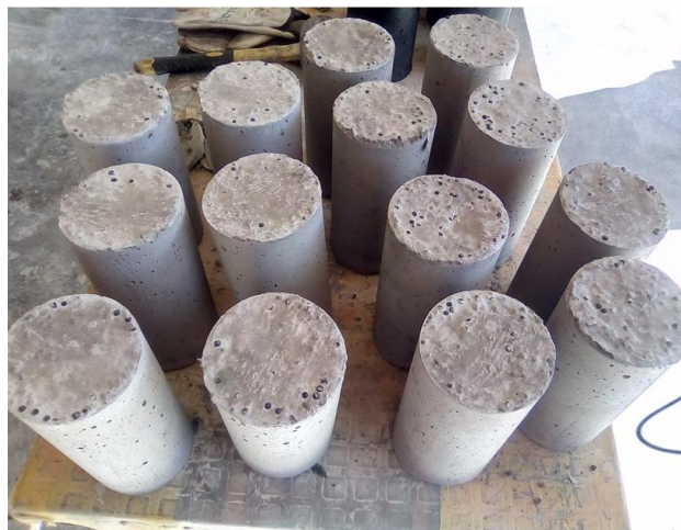
Imagen 17: Desencofrado de Especímenes.
