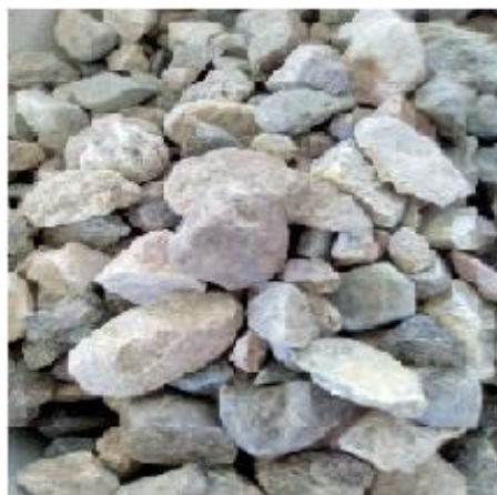
Imagen 8 Granulometría Agregado Grueso.
