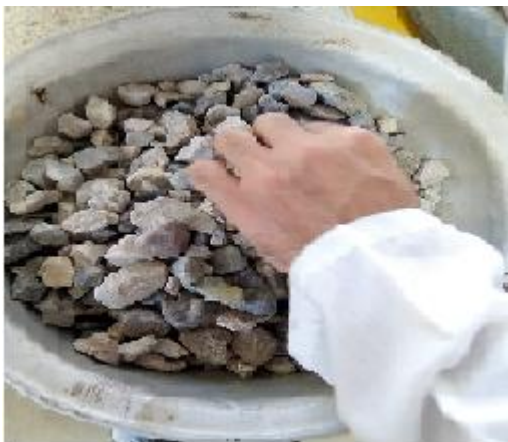
Imagen 8 Granulometría Agregado Grueso.
