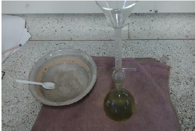
Imagen 9. Ensayo de densidad del Cemento con uso del frasco Le Chatelier.
