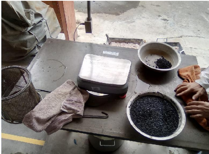
Imagen 5 Ensayo de Absorción Polietileno Reticulado
