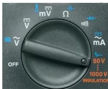
Figura 21. Perilla giratorio para selecciona la magnitud de la medición Fuente: Página oficial de TMG [19]
