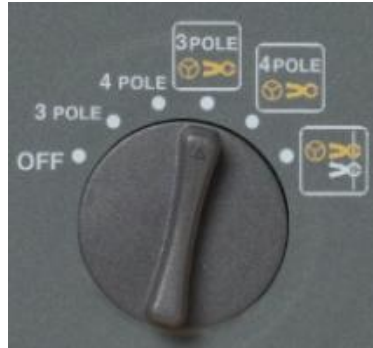
Figura 28. Perilla giratoria con las opciones de medición Fuente: Página oficial de Optimum Stores [24]
