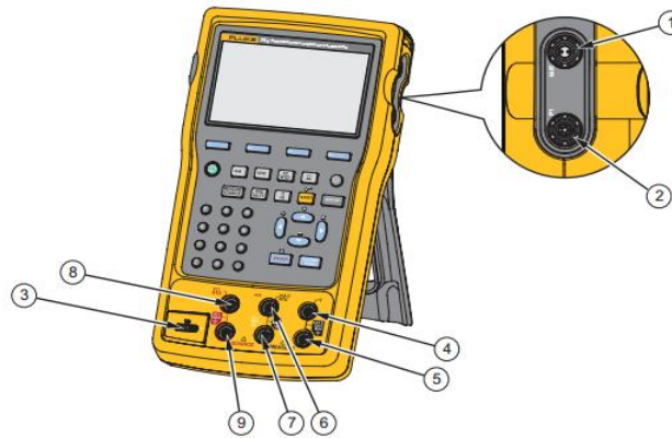
Figura 10. Entradas y salidas de multicalibrador 754 Fuente: Manual del equipo [13]
