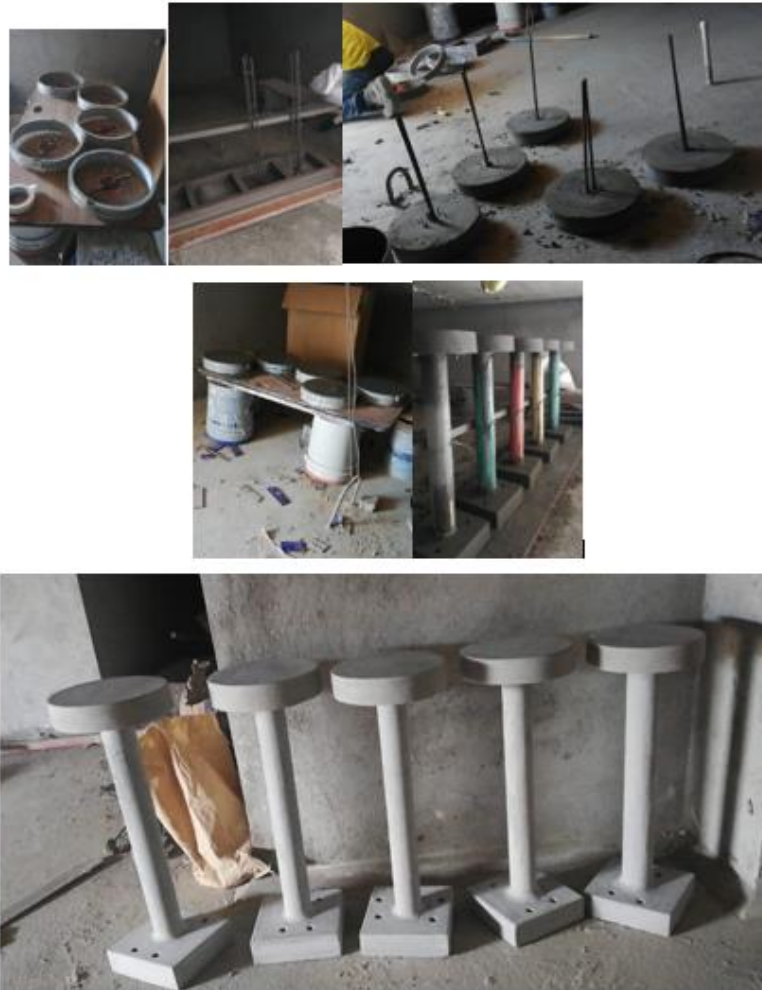
Ilustración 27 Procedimiento fundida bancas 26.
