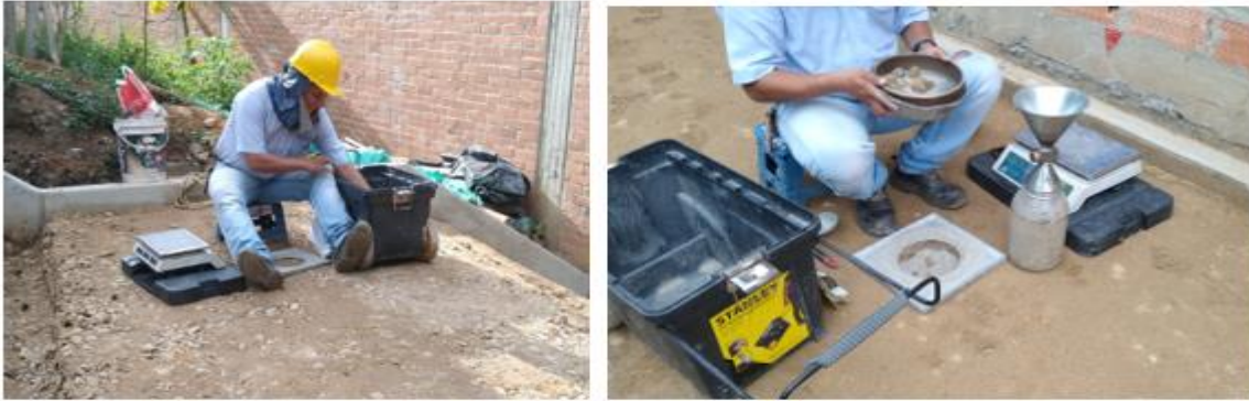
Ilustración 48 Ensayo cono de arena
