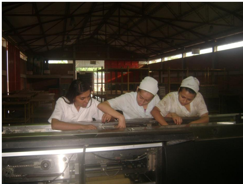
Imagen No 13 Limpieza interna de transportador
