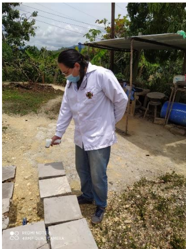
Imagen 14: Toma de temperatura cara expuesta al sol Fuente: propia
