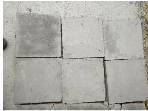
Imagen 13: Paneles finales con aditivos Fuente: El autor
