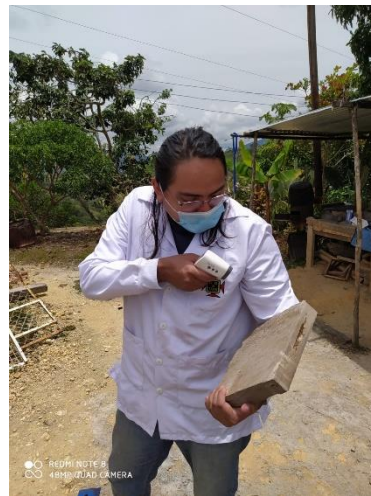
Imagen 15: Toma de temperatura cara opuesta Fuente: propia
