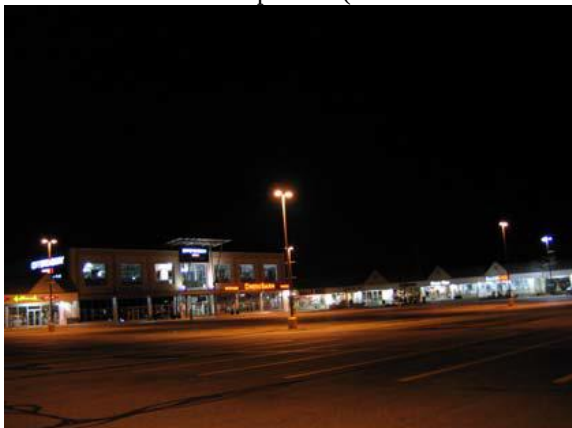
Figura 48 Parqueadero A con iluminación de sodio de alta presión (HPS)
