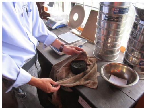
Secado de las briquetas para el peso S.S.S.
