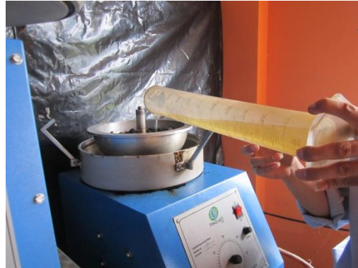
Adición de gasolina como solvente en el ensayo de Extracción Cuantitativa del Asfalto
