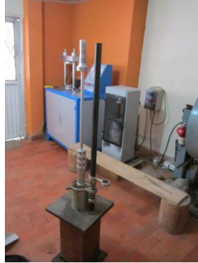
Pedestal para la elaboración de las briquetas de la BTAC tanto en campo como en el laboratorio
