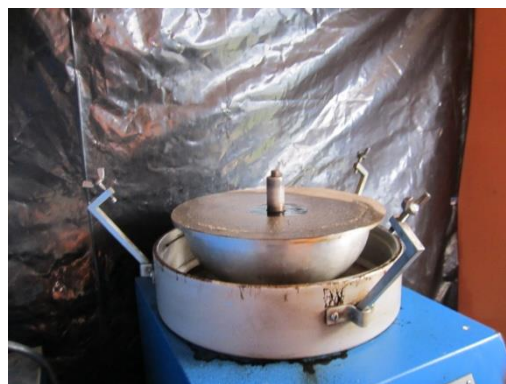
Preparación de la muestra de BTAC para el ensayo de Extracción de Asfalto
