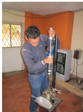
Elaboración de briquetas de la BTAC
