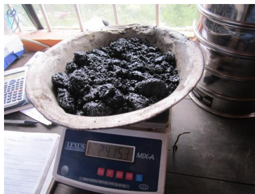
Pesaje muestra de BTAC para el ensayo de Extracción Cuantitativa del Asfalto
