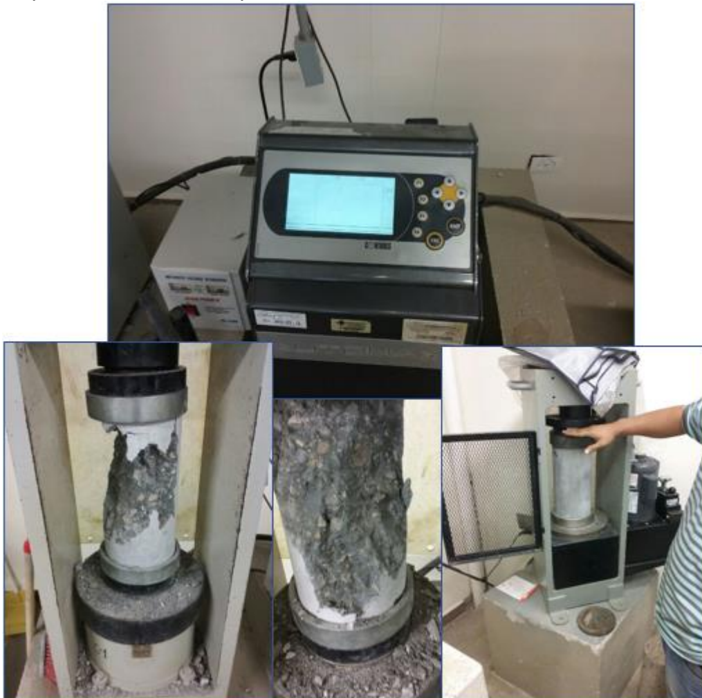
Figura 6, Ensayo Resistencia a la compresión en cilindros de concreto
