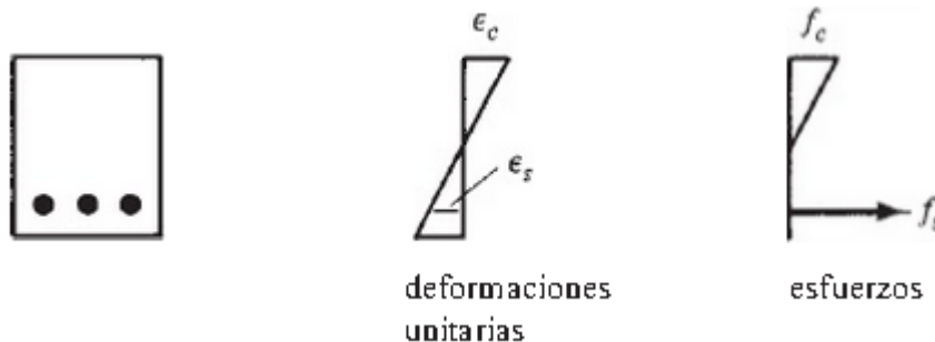
Figura 17, Concreto agrietado: etapa de esfuerzos elásticos,
