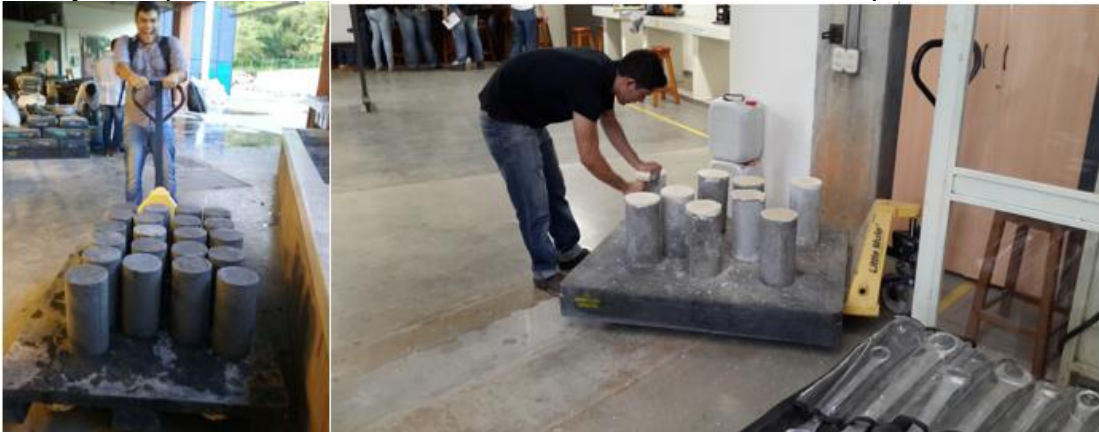
Figura 5, Transporte y Refrentado de cilindros para ensayo de módulo elástico
