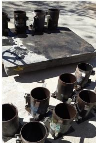
Figura 2, Formaletas utilizadas para la producción de cilindros de concreto
