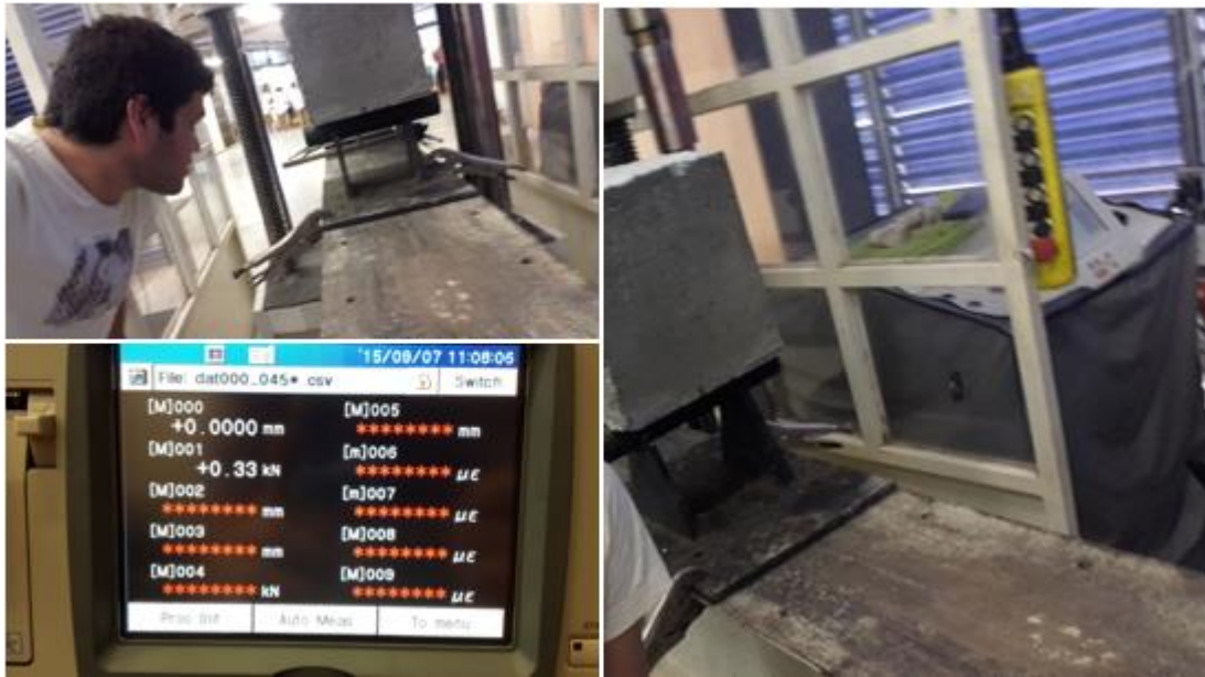
Figura 11, Toma de resultados del ensayo módulo elástico del concreto por medio de vigas ensayadas a flexión
