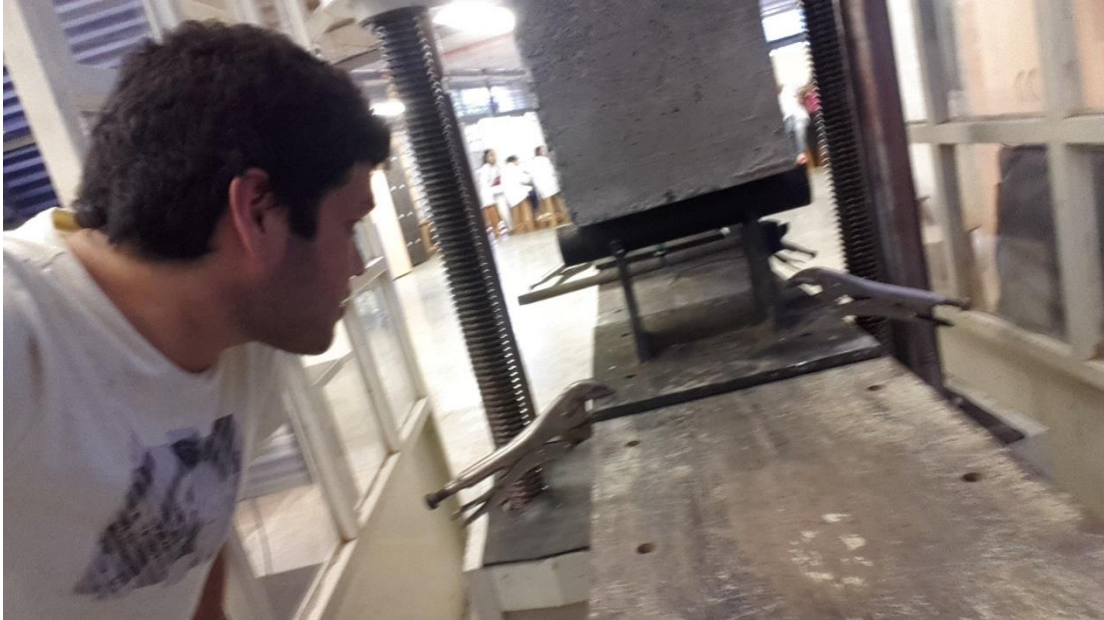
Figura 9, Montaje ensayo módulo elástico del concreto por medio de vigas ensayadas a flexión,
