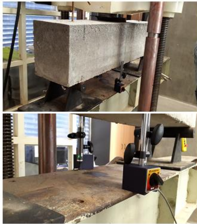
Figura 10, Montaje del dial de deformación para ensayo módulo elástico del concreto por medio de vigas ensayadas a flexión,
