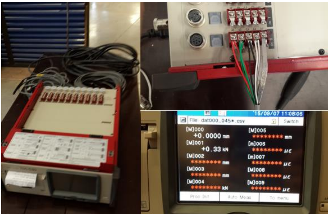
Figura 8, Datalogger para registro de fuerza y deformación en ensayo de módulo elástico
