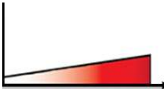
Figura 23 Patrón de falla C "Fatiga"
