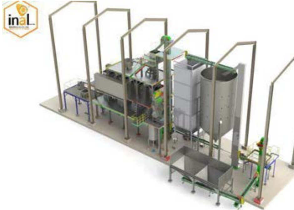
Figura 110 Estructura metálica de una planta extractora de aceite de palmiste
