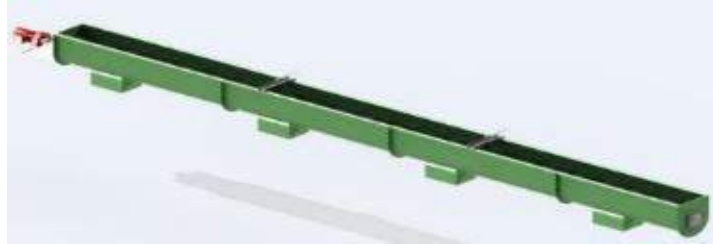
Figura 38 Sin fin distribuidor de almendra húmeda a silos
