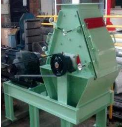
Figura 54 Molino de martillos de la almendra seca
