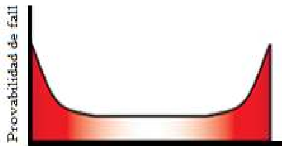
Figura 21 Patrón de falla A "La curva de la bañera"
