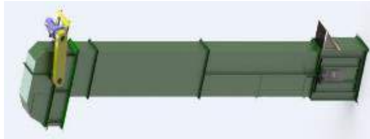
Figura 34 Elevador de cangilones de la almendra húmeda
