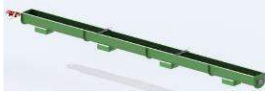
Figura 59 Sin fin distribuidor de almendra partida
