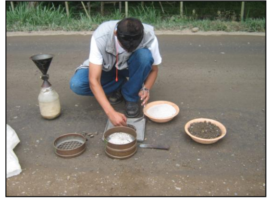
Tomando ensayo de densidad
