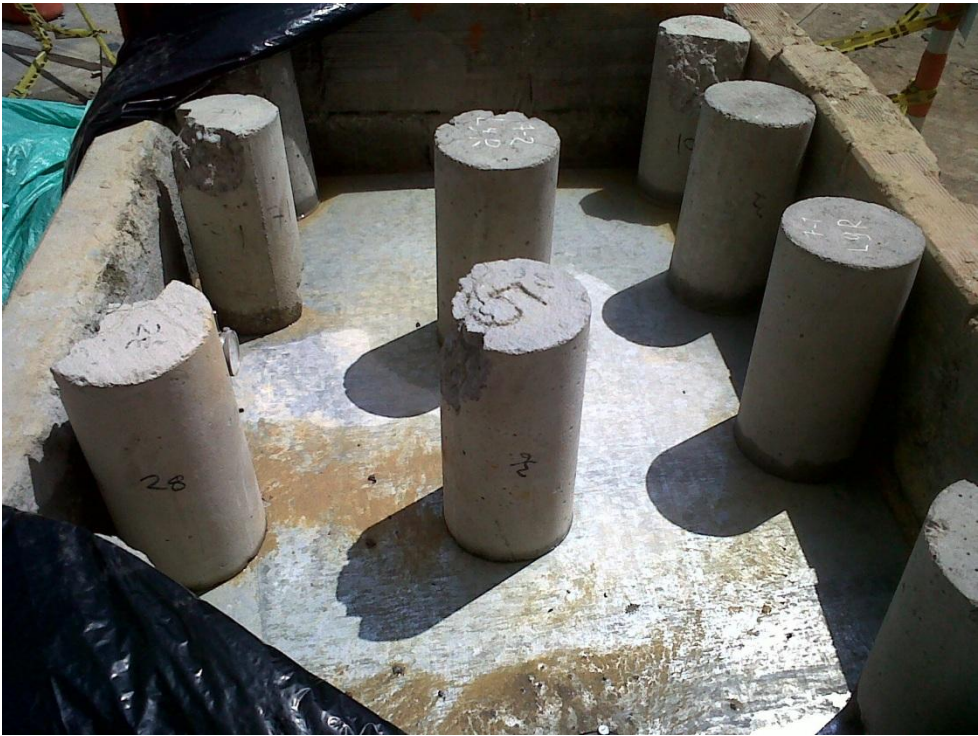
Carga de 0.01 kg/ cm 2 usando cilindros de concreto.
