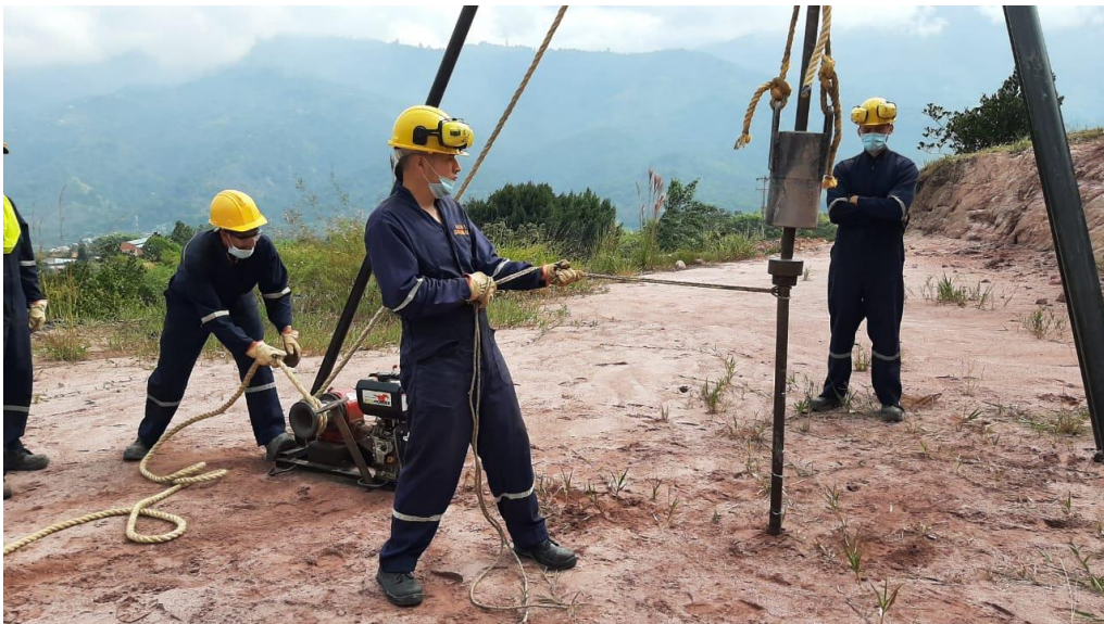
Imagen 20. Ejecución de ensayo SPT
