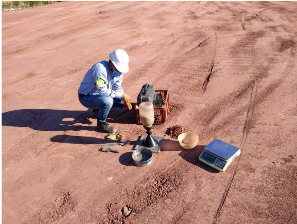
Imagen 14. Ejecución del ensayo de cono y arena
