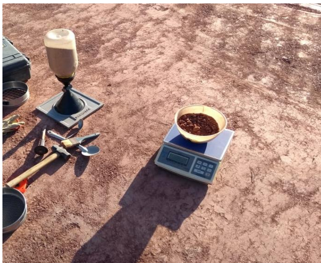
Imagen 32. Toma de datos del ensayo de densidades de campo, Vientos de Llanada.
