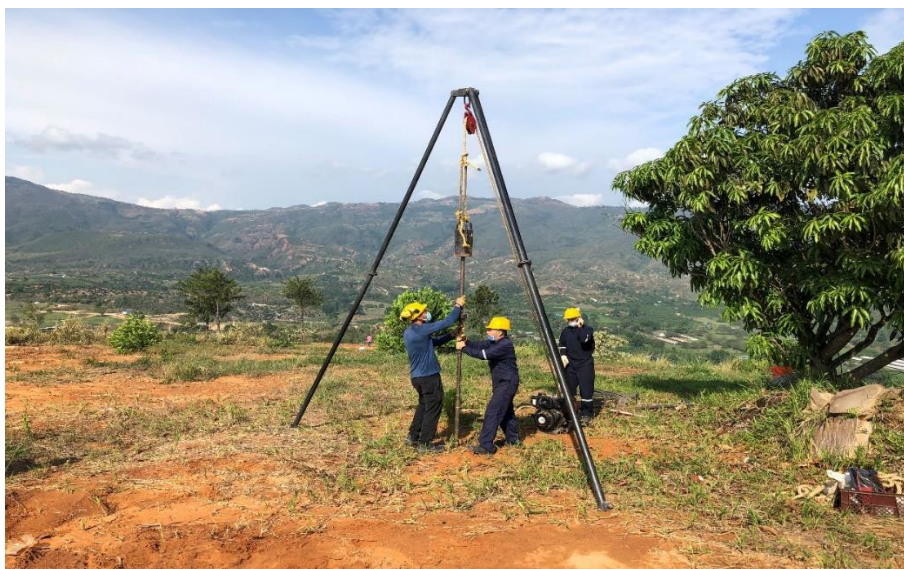
Imagen 22. Ejecución de ensayo SPT
