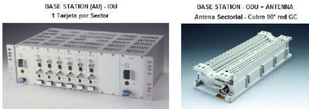
Figura 3. Indoor Unit de AU. Outdoor Unit de AU con antena.
