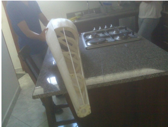
Figura 60. Ensamble del fuselaje vista trasera del prototipo.
