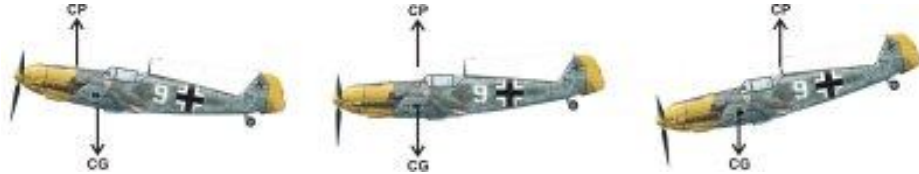
Figura 10. Posición del centro de presión respecto al centro de gravedad.
