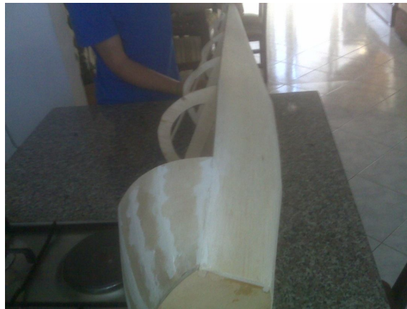
Figura 59. Ensamble del fuselaje vista delantera del prototipo.
