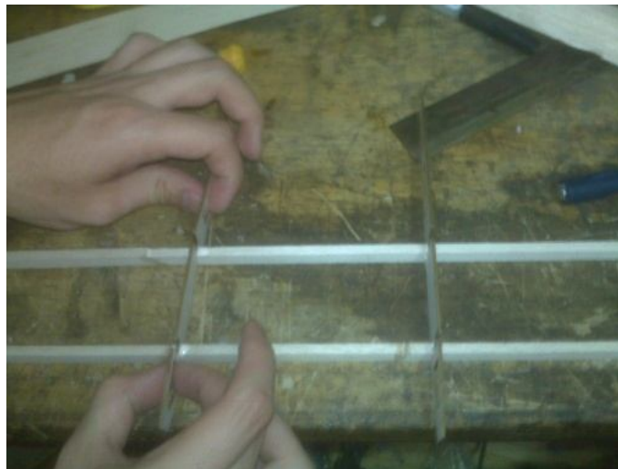
Figura 64. Pegado de las costillas de las alas.
