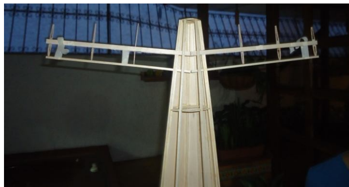
Figura 67. Ensamble del estabilizador horizontal del prototipo.
