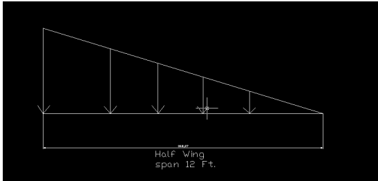
Figura 31. Vista de la distribución de cargas en el ala.
