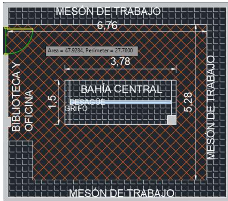
Ilustración 5 Planta laboratorio PTAR
