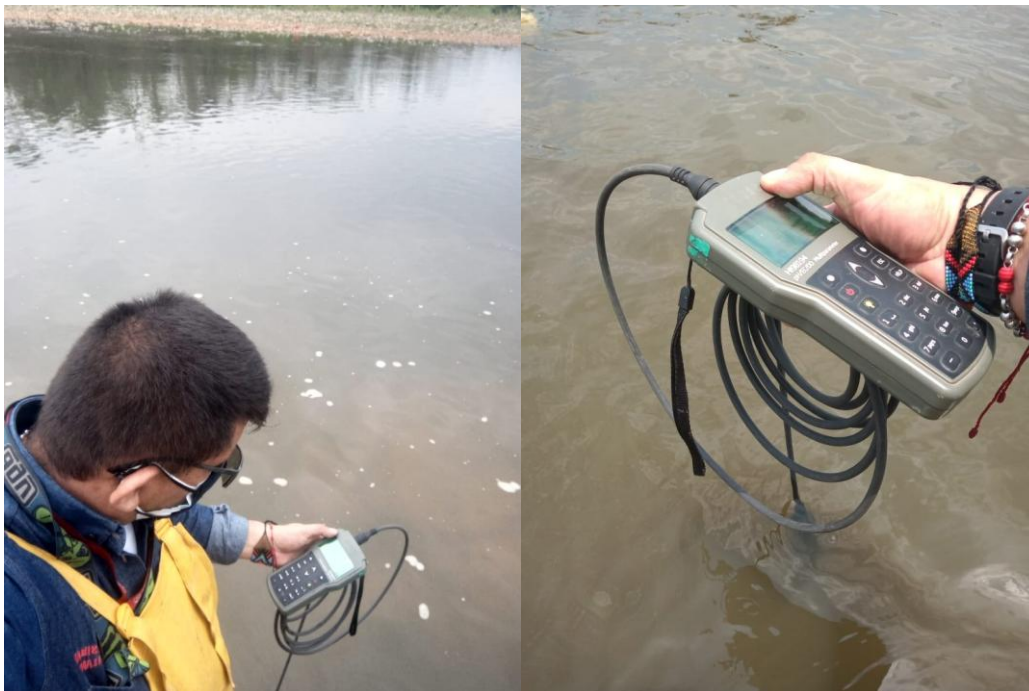
Foto A3-4. Registro de pH y oxígeno disuelto. Año: 2025. Área: Estanques seleccionados para monitoreo. Descripción: Evidenciar el proceso de medición de parámetros críticos de calidad del agua, relevantes para los lineamientos BPPA.
