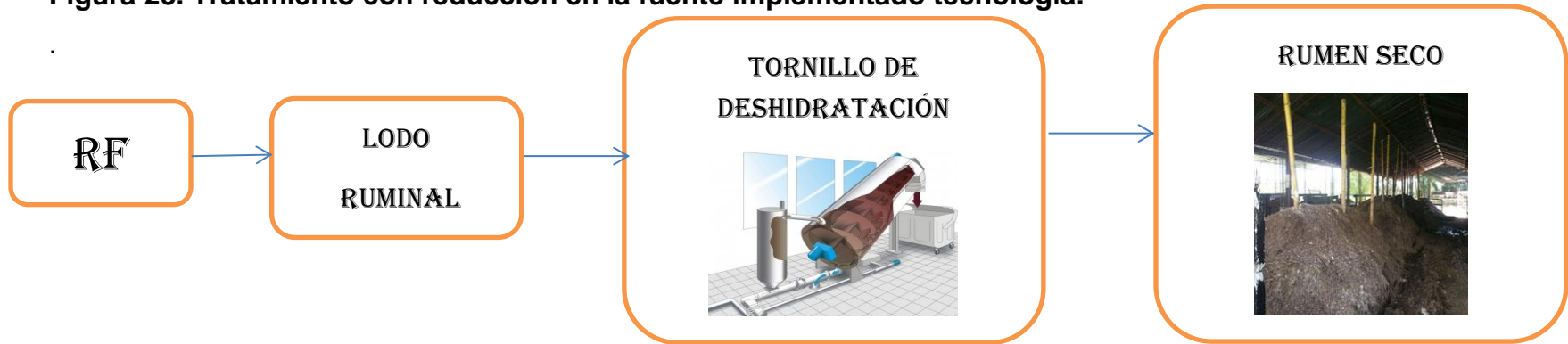
Figura 28. Tratamiento con reducción en la fuente implementado tecnología.
