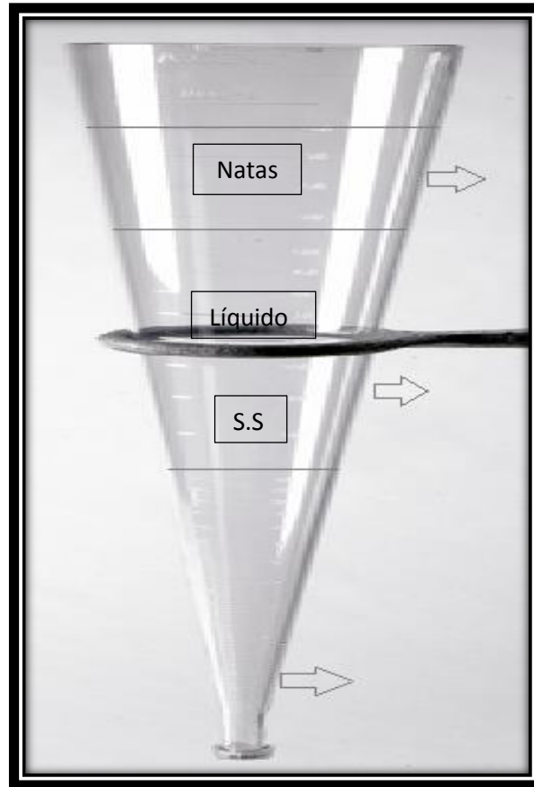
Figura 17. Determinación de sólidos sedimentables.
