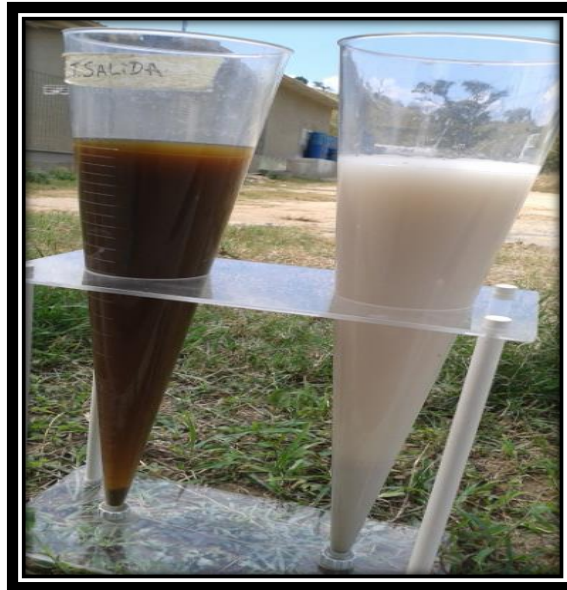
Figura 16. Montaje para determinación de sólidos en sedimentables.
