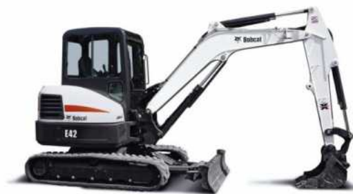
Figura 11. Mini Excavadora E42
