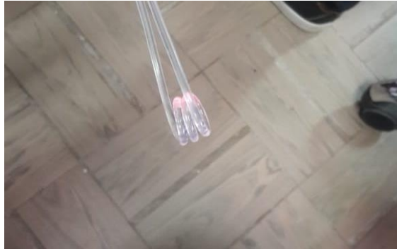
Figura 14: Fibra flexionada con 3 espiras. Fuente: Autor
