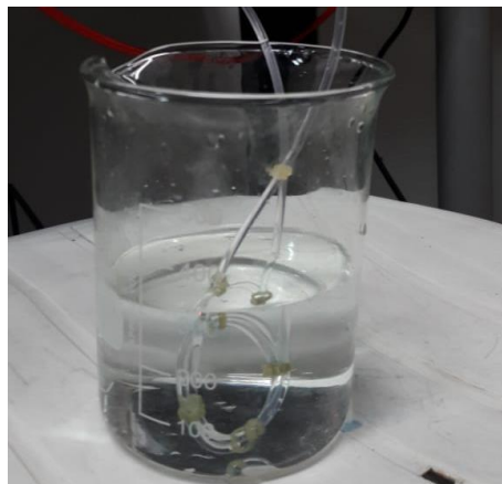
Figura 13: Prueba en agua con Fibra flexionada. Fuente: Autor
