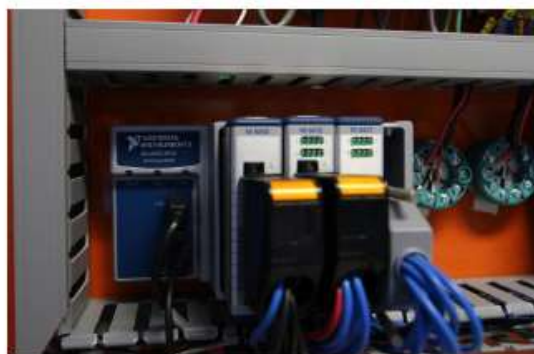
Figura 34. Sistema de Adquisición de Datos Usado en el Módulo de flujo
