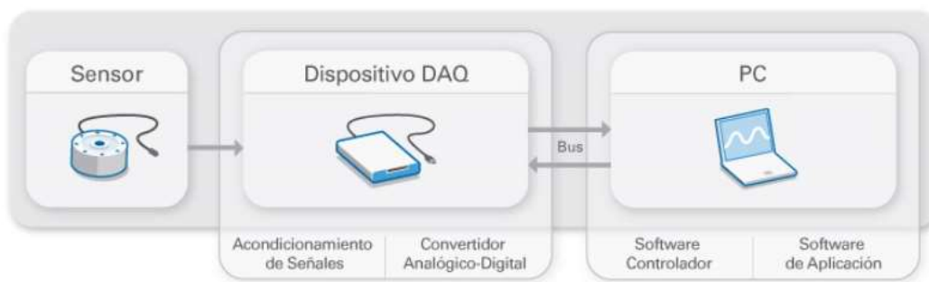
Figura 33. Partes de un sistema DAQ
