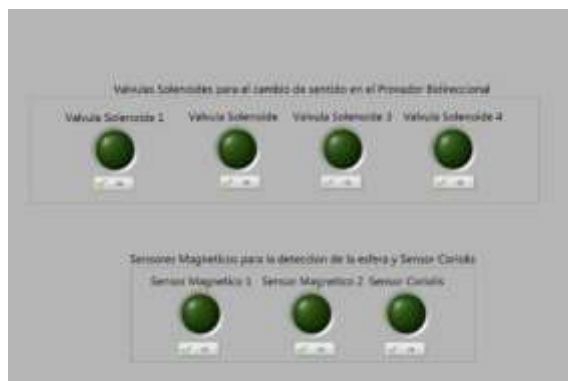
Figura 64. Monitoreo del Hardware en la HMI.
