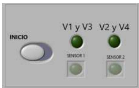
Figura 53. Botón de inicio y leds para verificar el estado de las válvulas y los sensores magnéticos
