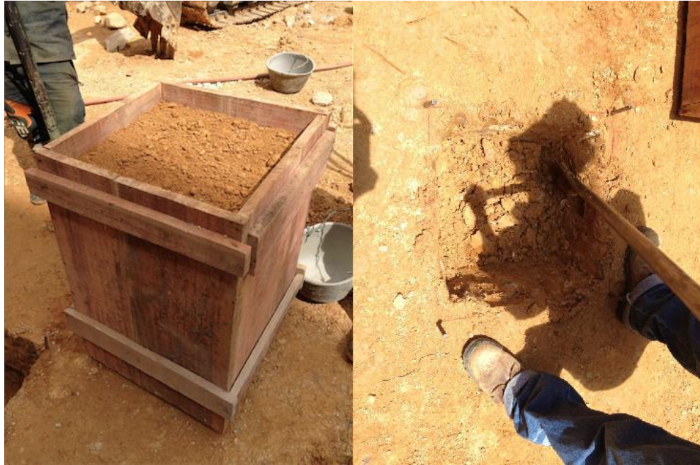
Foto 5 Excavación del terreno y relleno del material en el recipiente.
