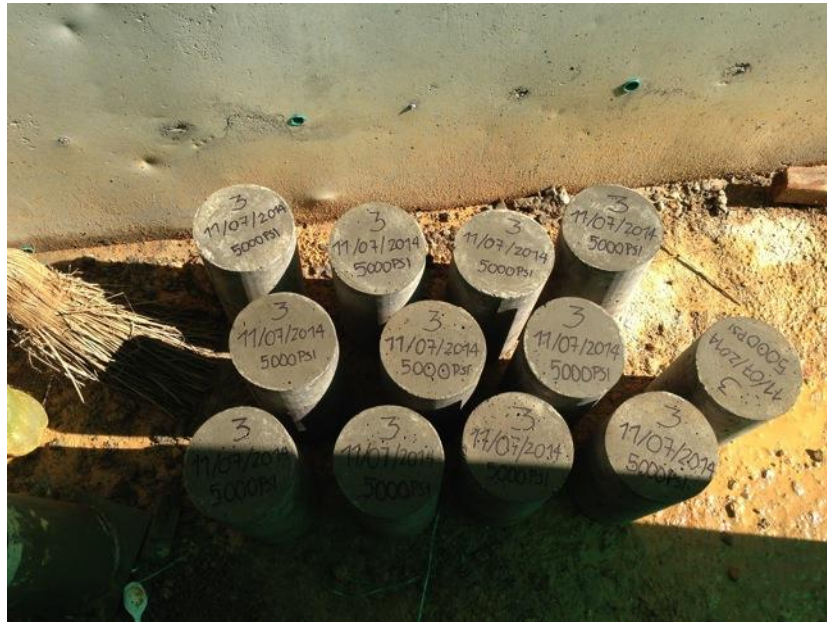
Foto 86 Especímenes de concreto tomados en obra y debidamente etiquetados.
