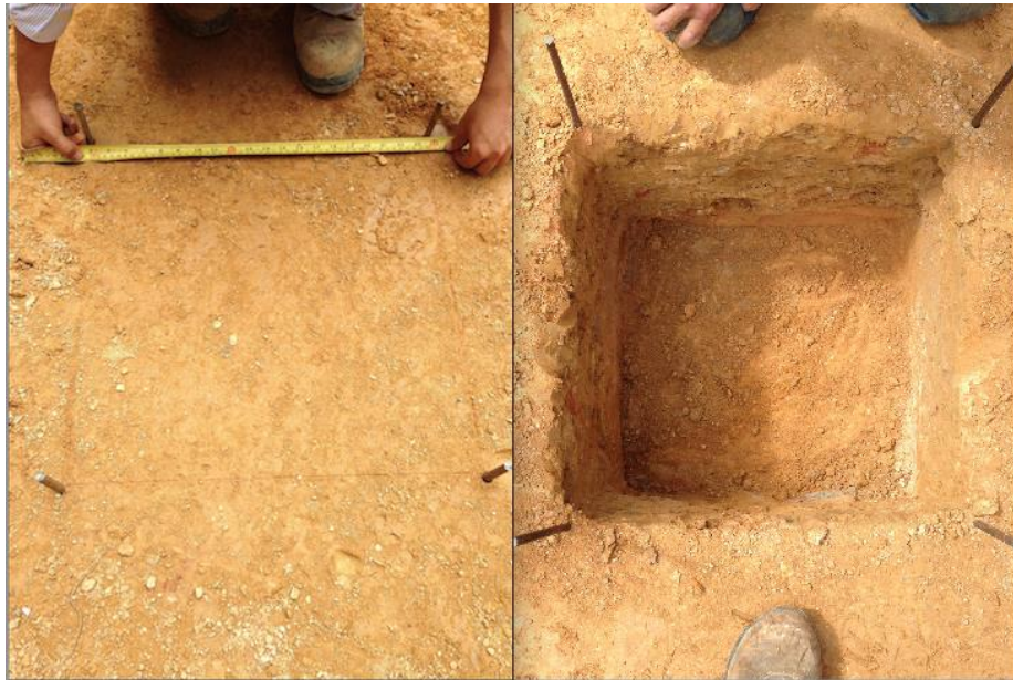
Foto 2 Medición y excavación del volumen en banco In-situ.
